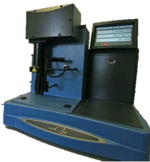
Slika 3.16 Termogravimetrijski analizator Q500
