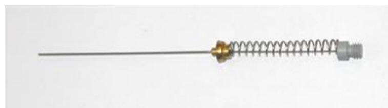
Slika 3.19 Vlakno s ovojnicama DVB/CAR/PDMS (sivo vlakno)
