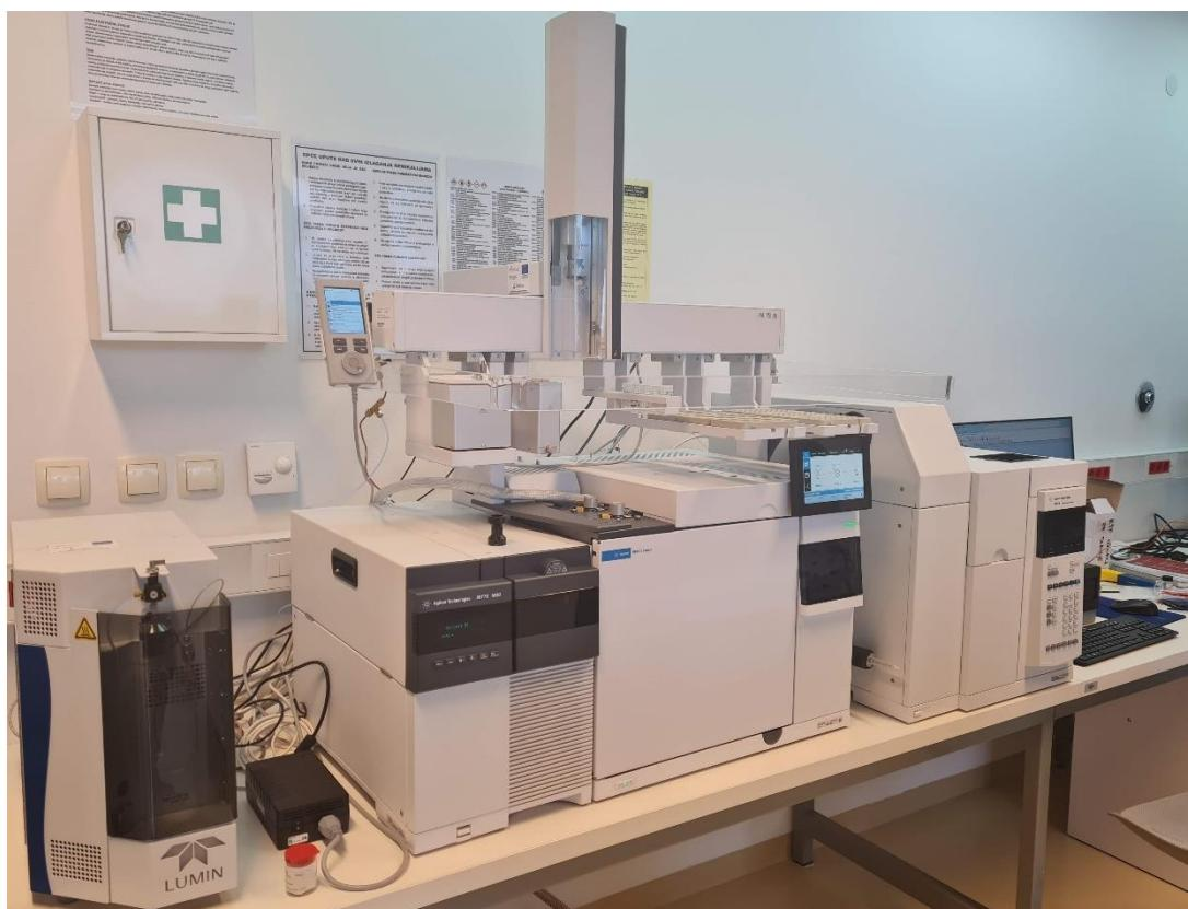
Slika 3.20 Vezani sustav plinska kromatografija-spektrometrija masa (GC-MS)
