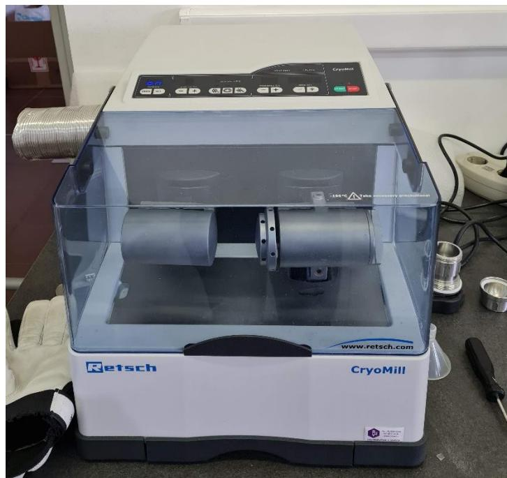
Slika 3.9 Retsch CryoMill uredaj za kriomljevenje uzorka
