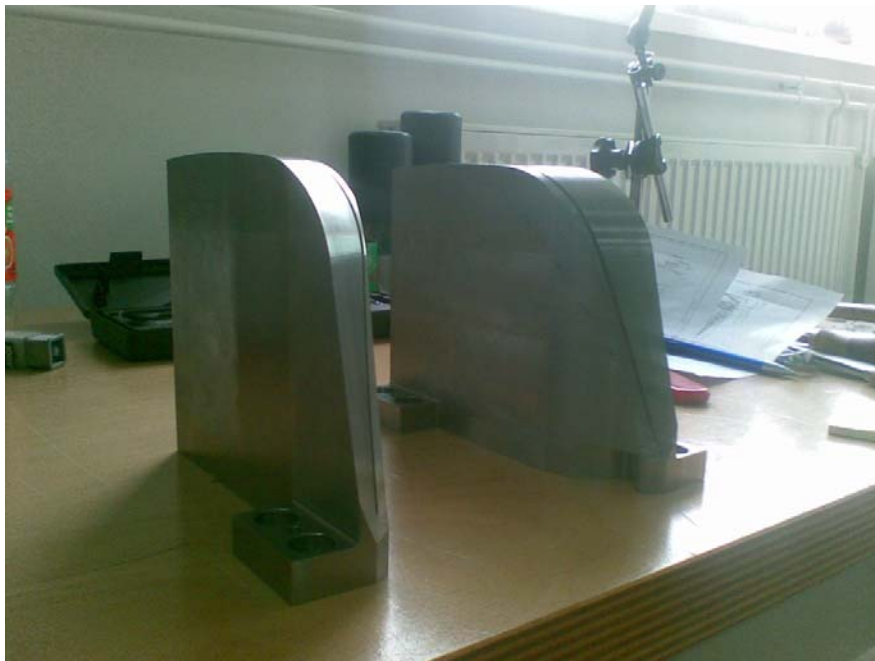
Slika 12.3. Izradak dobiven obradom na 5-osnom CNC stroju
