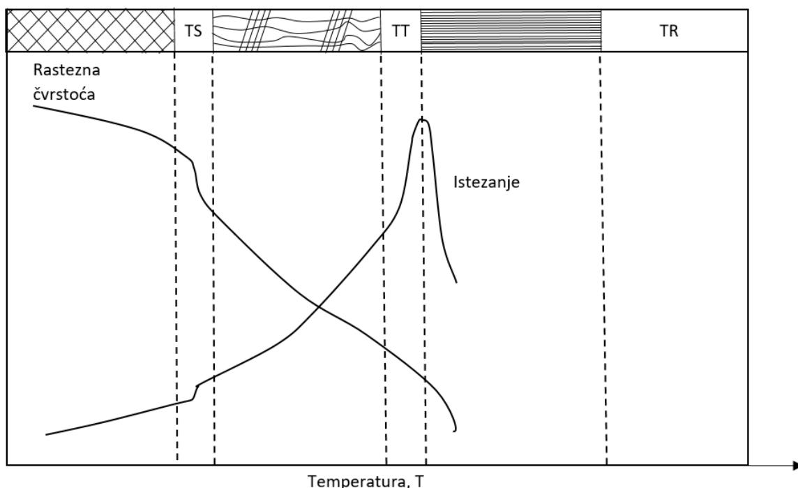
Slika 10. Temperaturna ovisnost mehaničkih svojstava kristalastih plastomera [8]
