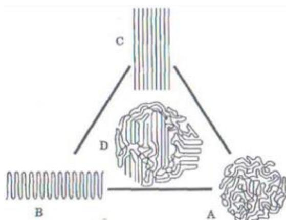
Slika 7. Nadmolekularna struktura plastomera po stupnju uredenosti strukture [7]
