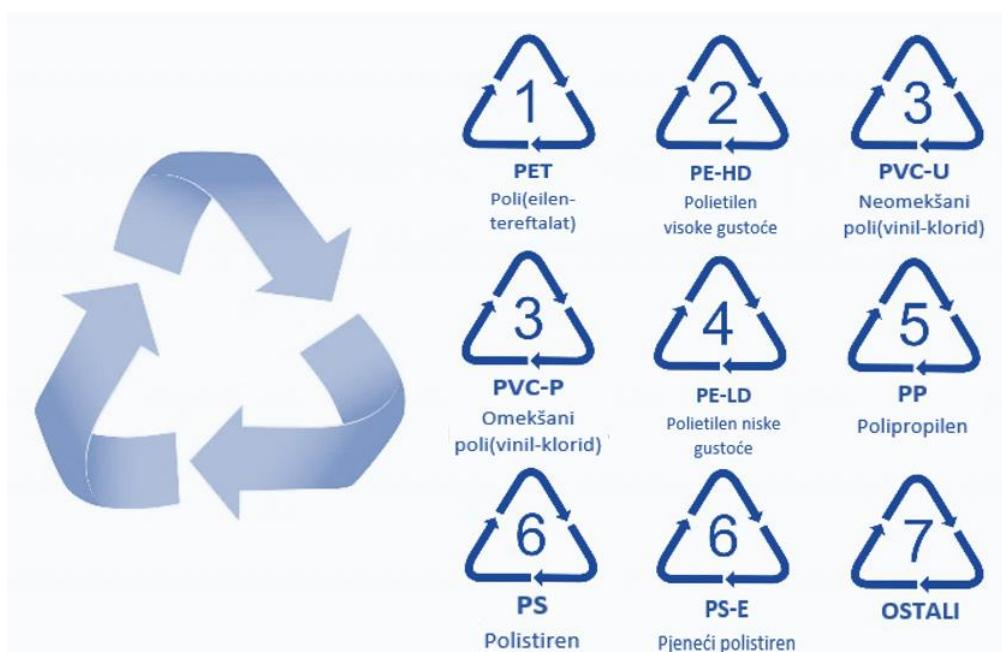
Slika 27. Univerzalni simboli recikliranja (lijevo) i kodovi polimernih materijala (desno) [22]
