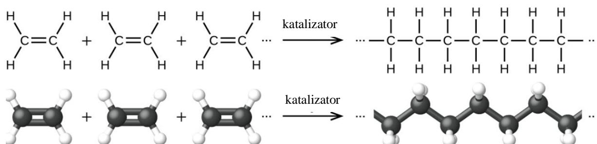
Slika 4. Primjer monomera (lijevo) i makromolekule polimera (desno) [4]
