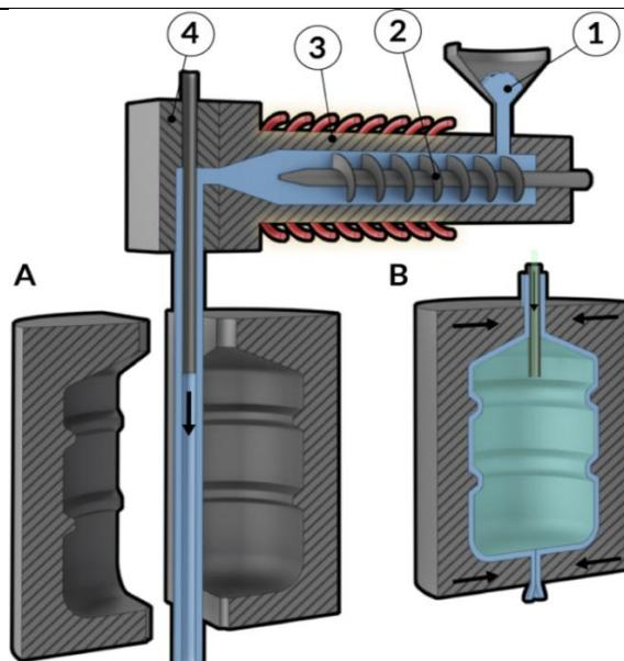
Slika 25. Primjer ekstruzijskog puhanja [20]
