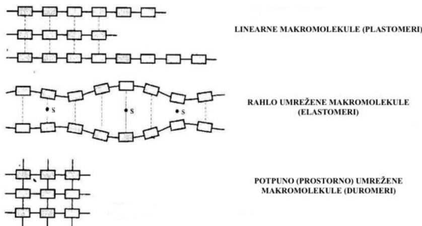
**Slika 6. Podjela polimera po postojanosti na povišenim temperaturama [6]**
