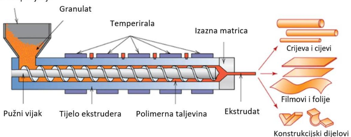
Slika 17. Dijelovi ekstrudera [16]
