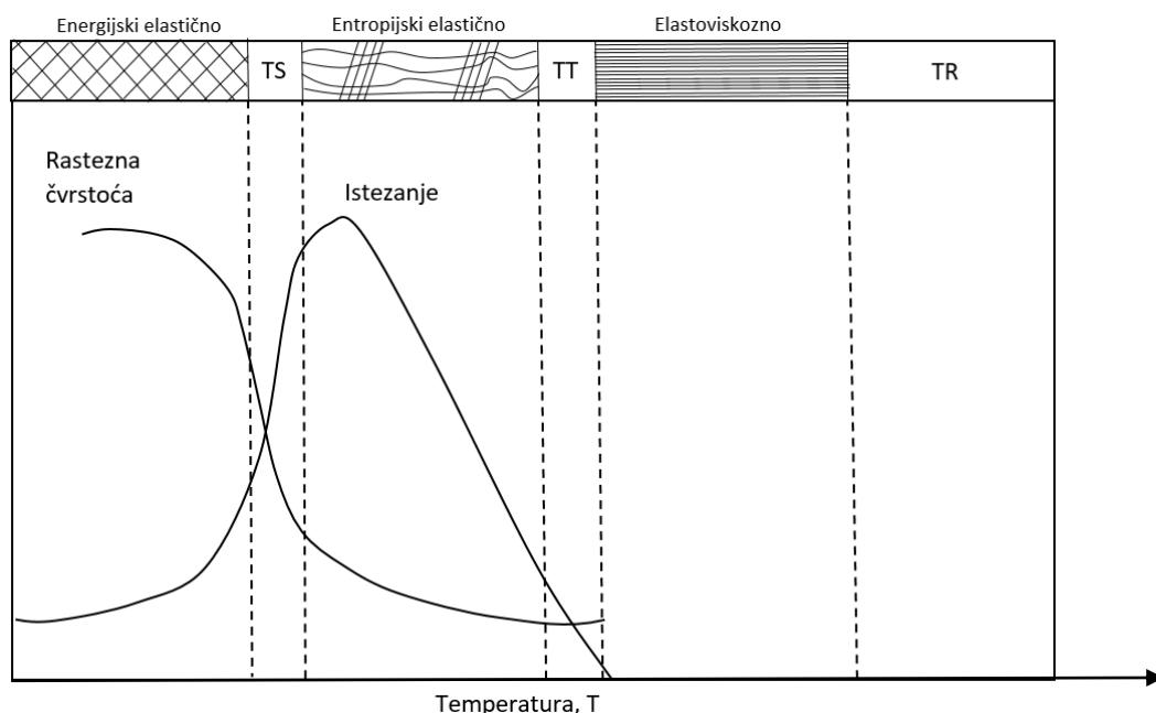
Slika 9. Temperaturna ovisnost mehaničkih svojstava amorfnih plastomera [8]
