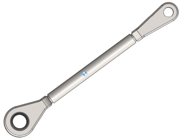
Slika 38. Konstrukcija štapa k2 s naznačenim težištem
