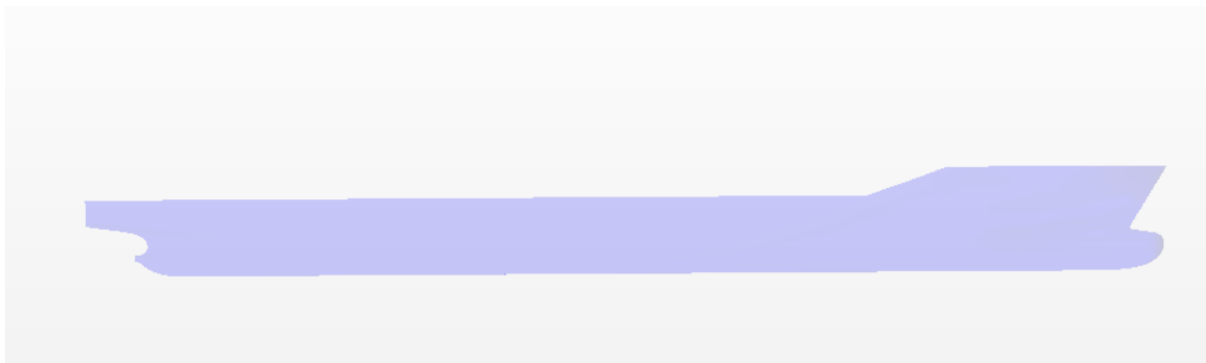
Slika 26. Model broda sa zategom od 0,4^\circ
