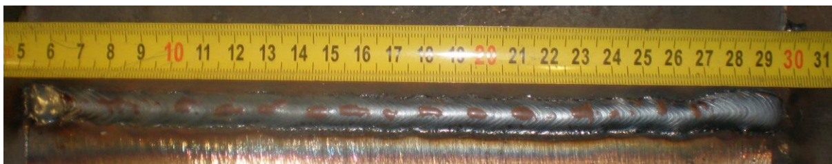
Slika 4.50 Cjeloviti prikaz trećeg prolaza uzorka 3 sučeljenog spoja
