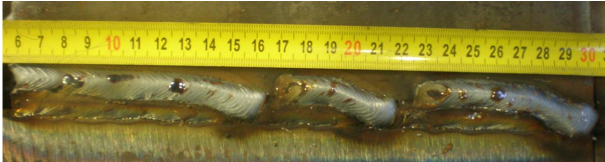
Slika 4.44 Cjeloviti prikaz posljednjih triju prolaza uzorka 2 sučeljenog spoja
