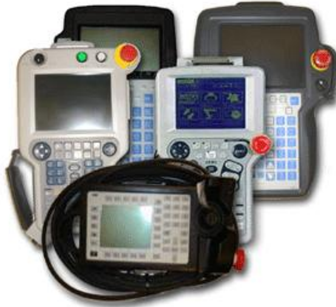
Slika 3.10 Upravljačke ploče različitih industrijskih robota [7]
