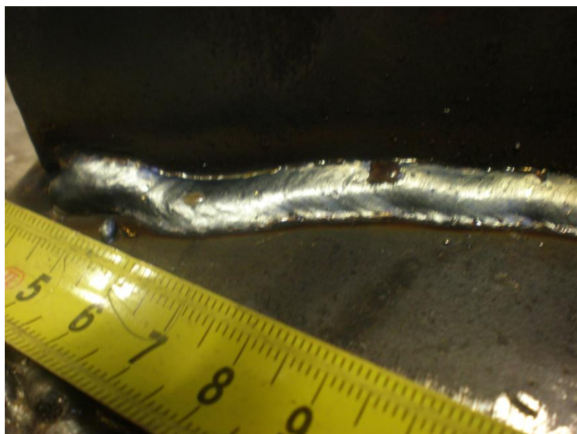
Slika 4.58 Početno odstupanje zbog utjecaja zazora kod uzorka 2
