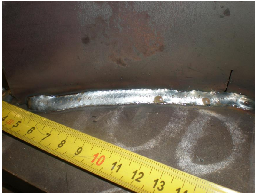
Slika 4.62 Izgled zavora uzorka 3 kutnog spoja u području prije ureza
