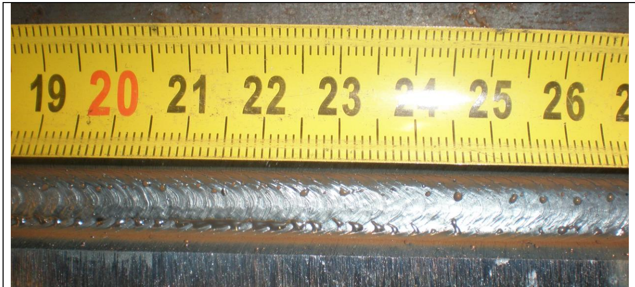
Parametri zavarivanja (prijenos metala kratkim spojevima)
