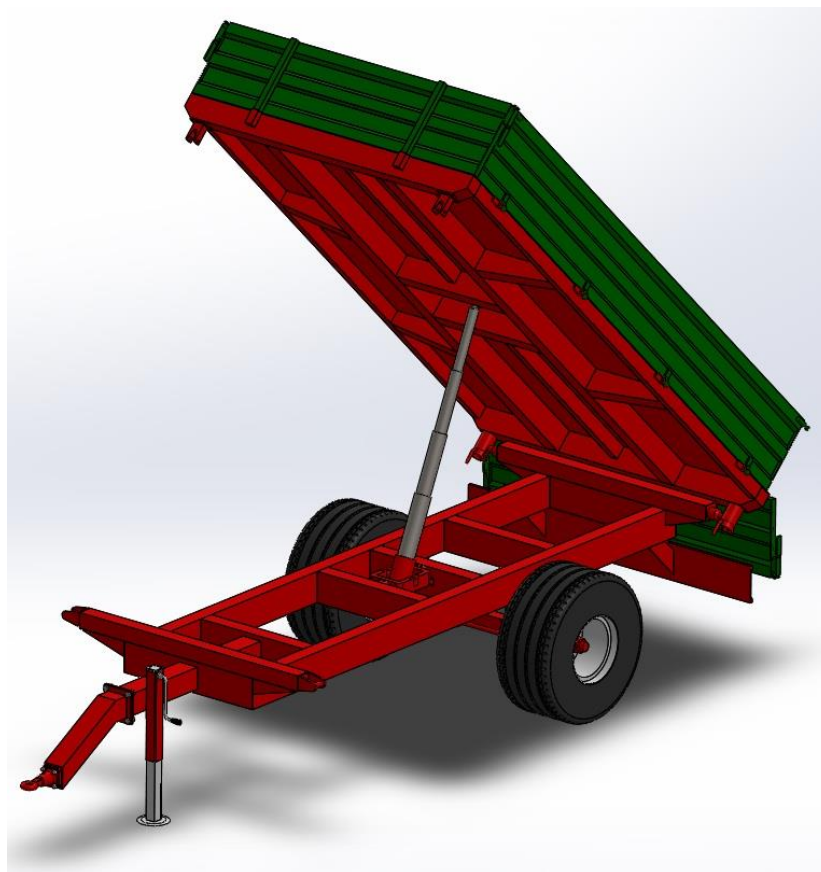
Slika 42. 3D prikaz prikolice s nagibom sanduka od 45° unazad s prednje strane
