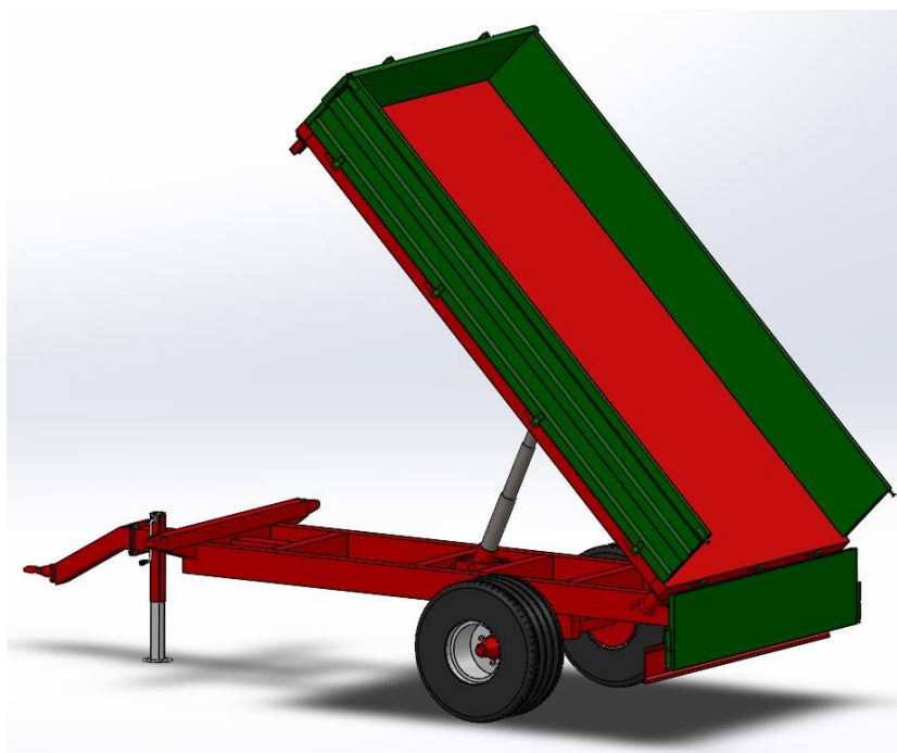
Slika 43. 3D prikaz prikolice s nagibom sanduka od 45° unazad sa stražnje strane
