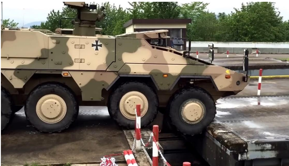
Slika 18. Prelazak vozila na kotačima preko rova [21]
