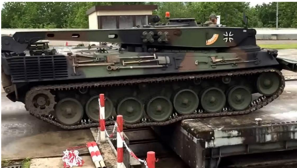
Slika 16. Prelazak vozila na gusjenicama preko rova [21]
