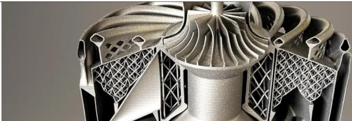
Slika 5. Turbina dobivena SLM postupkom [19]
