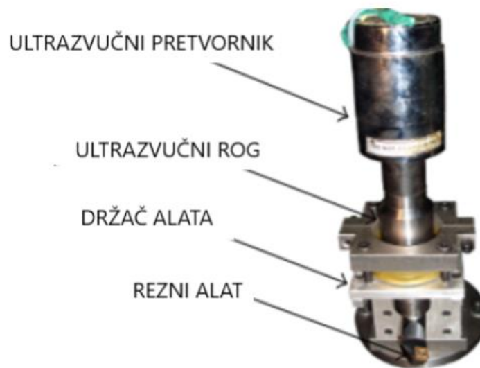
Slika 24. Struktura alata i vibracijskog sustava [22]
