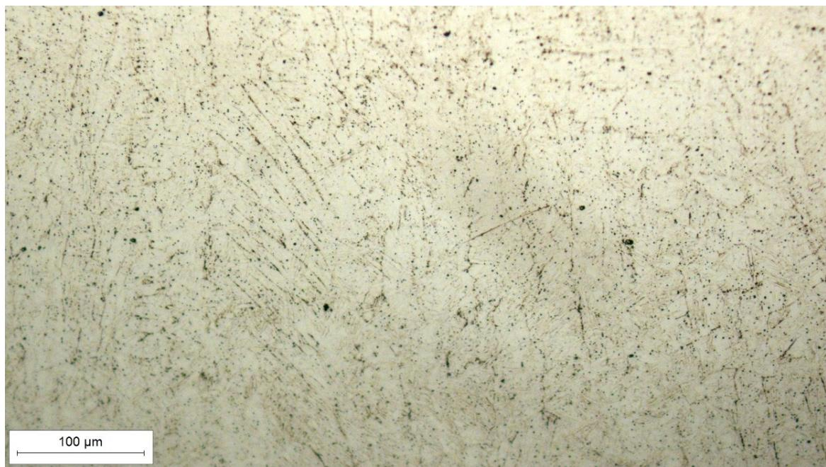
Slika 31. Mikrostruktura metala zavara snimljena pri povećanju 200×
