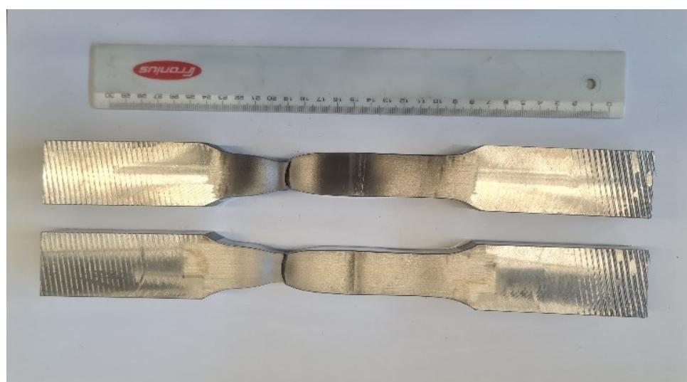
Slika 42. Epruvete za ispitivanje vlačne čvrstoće
