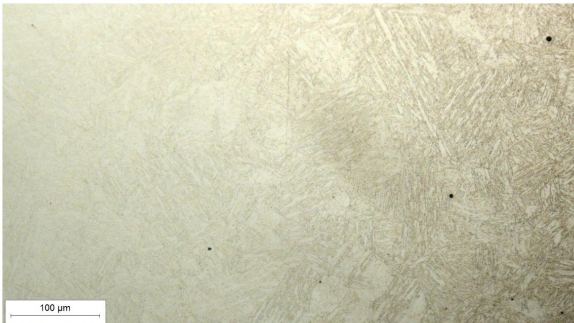
Slika 34. Mikrostruktura ZUT-a korijena zavara snimljena pri povećanju 200×
