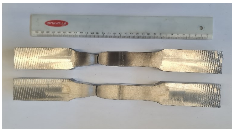
Slika 42. Epruvete za ispitivanje vlačne čvrstoće
