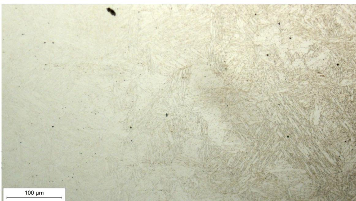
Slika 35. Mikrostruktura ZUT-a u sredini zavara snimljena pri povećanju 200×
