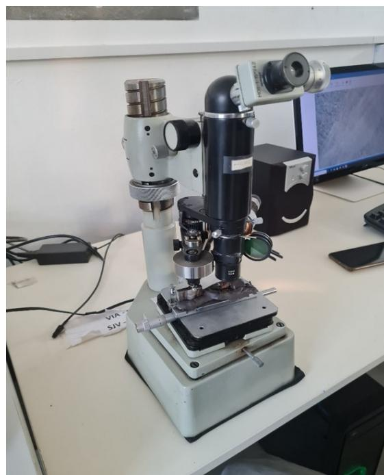
**Slika 38. Mikrotvrdomjer PMT-3U4.2**
