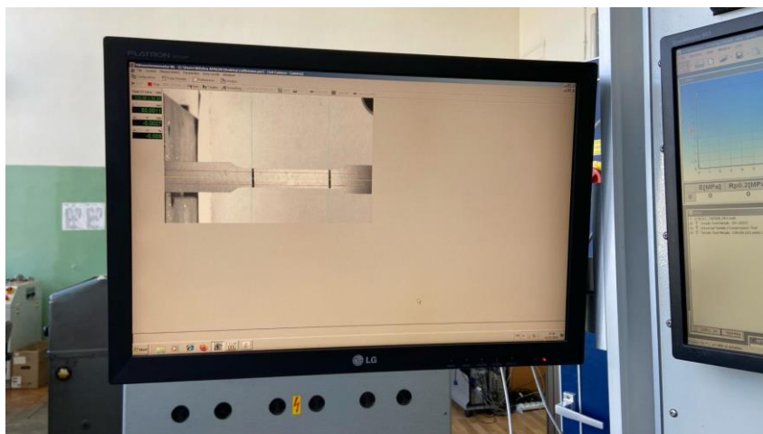
Slika 5. Zaslon sa videoekstenziometrom na kidalici
