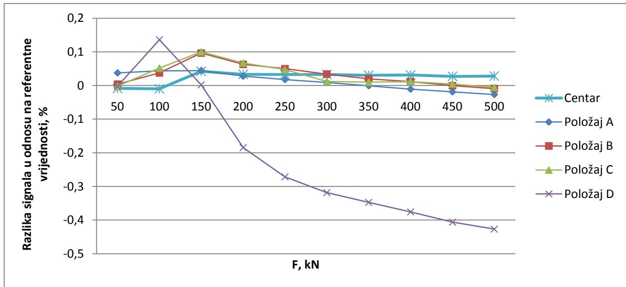
Slika 46. Razlika signala u odnosu na referentne vrijednosti za svih pet ispitnih položaja i rastuće nizove bez rotacije
