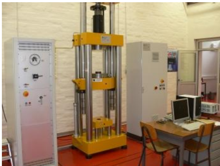
Slika 2. Referentni etalon sile [13]
