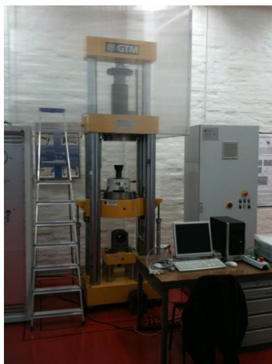
Slika 26. Referentni etalon sile u Laboratoriju za ispitivanje mehaničkih svojstva
