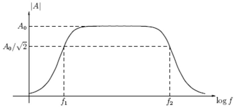
Slika 21. Frekvencijska karakteristika pojednostavljenog propusnog filtra
