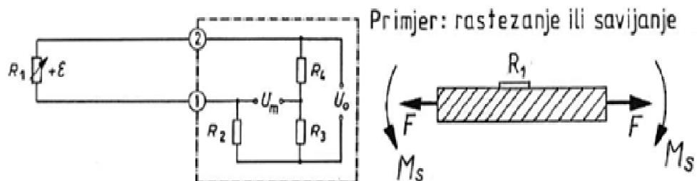
Slika 17. Tenzometarska (mjerena traka) u spoju četvrtinskog mosta i primjer uporabe
