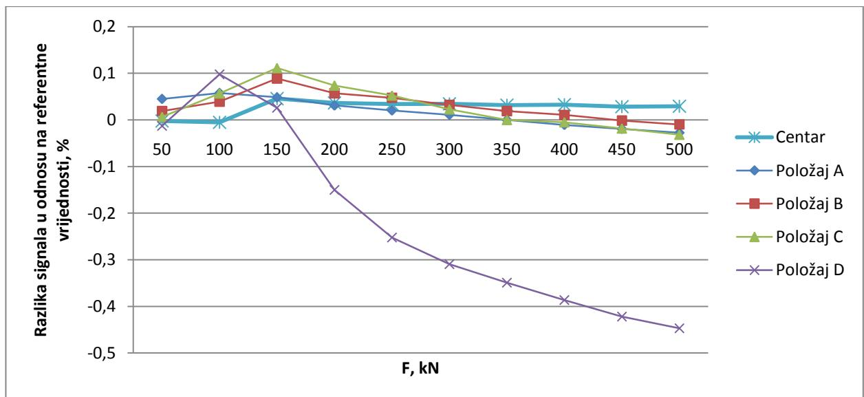
Slika 47. Razlika signala u odnosu na referentne vrijednosti za svih pet ispitnih položaja i rastuće nizove sa rotacijom
