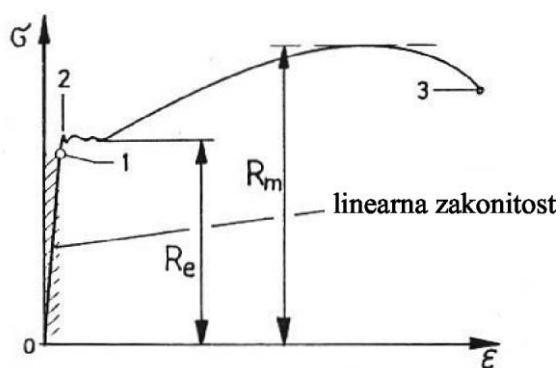
Slika 9. Dijagram naprezanje – istezanje za niskougljični čelik
