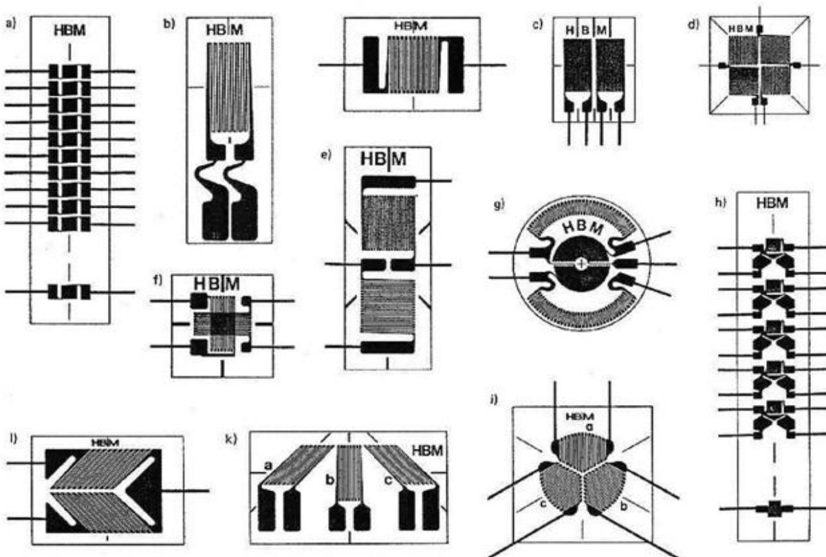
Slika 11. Različiti tipovi elektrootporničkih mjernih traka i rozeta
