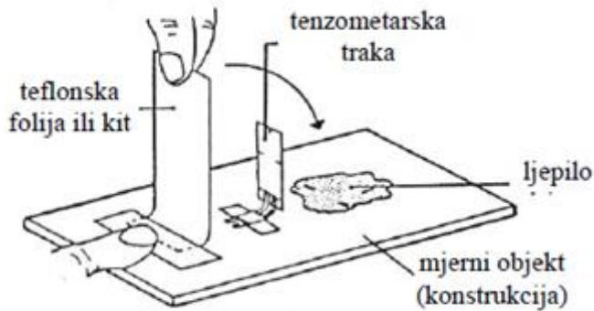
Slika 12. Lijepljenje mjerne trake na ispitni objekt
