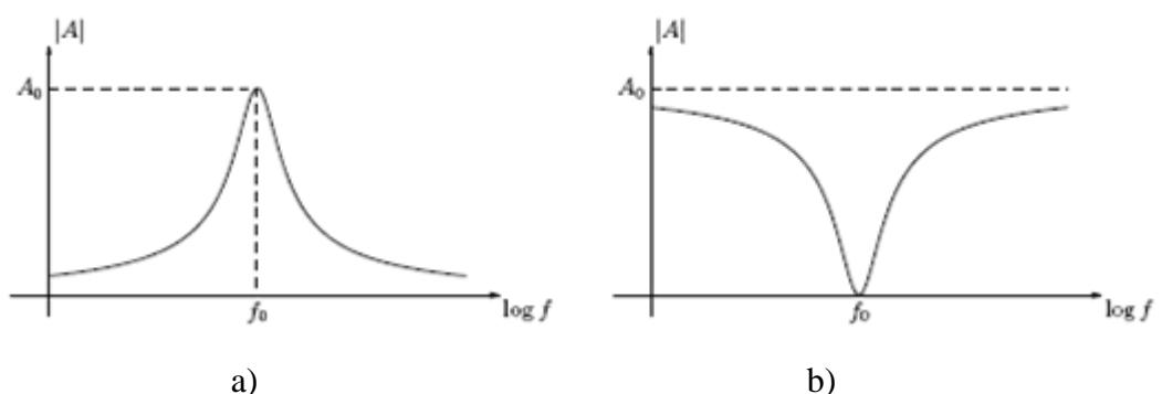
Slika 23. Frekvencijska karakteristika uskopojasnog filtra
