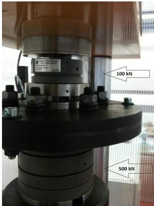
Slika 27. Dvostruko složeni dinamometri referentnog etalona sile
