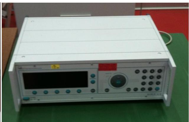
Slika 29. Mjerno pojačalo DMP40
