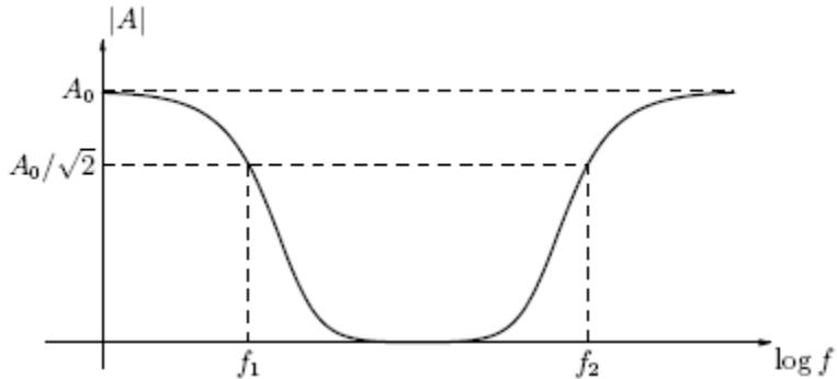
Slika 22. Frekvencijska karakteristika pojedostavljenog nepropusnog filtra
