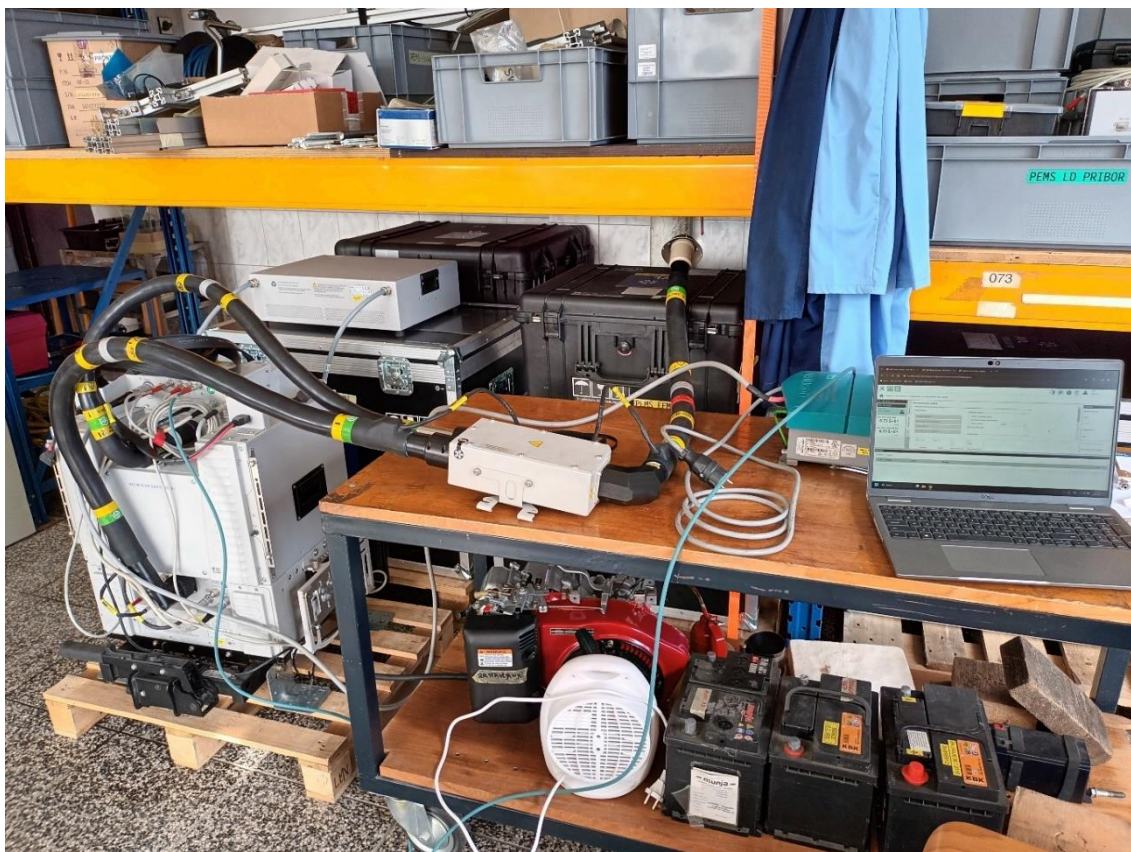
Slika 4.5. Ispitni postav za mjerenje čestica uređajem AVL M.O.V.E - PN PEMS
