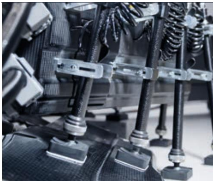
Slika 27. Vakuumski sustav prilagodljivih nožica [23]
