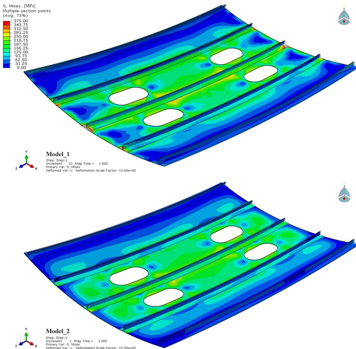
Slika 27. Ekvivalentna napreznja po von Mises-u [MPa]
