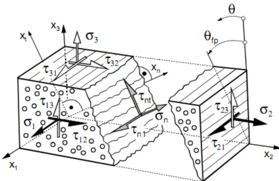
Slika 12. Naprezanja u ravnini popuštanja jednosmjerenog kompozitnog materijala [9]
