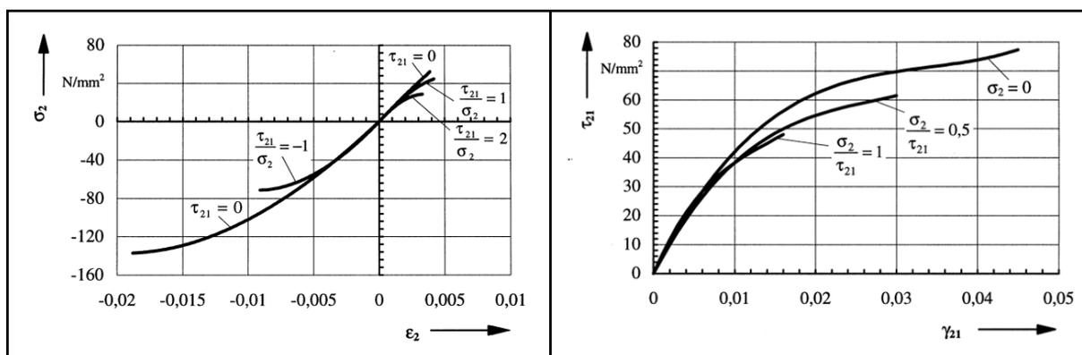
**Slika 11. Dijagrami naprezanje/istezanje za jednousmjereni kompozit staklo/epoksid [9]**
