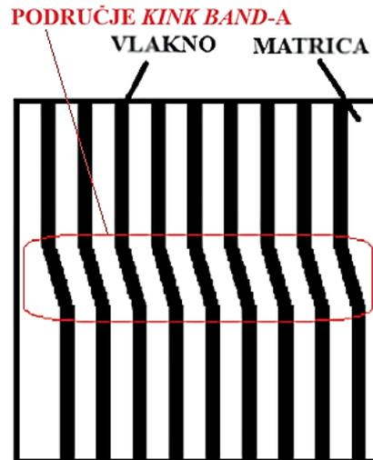
Slika 7. Izvijanje vlakna
