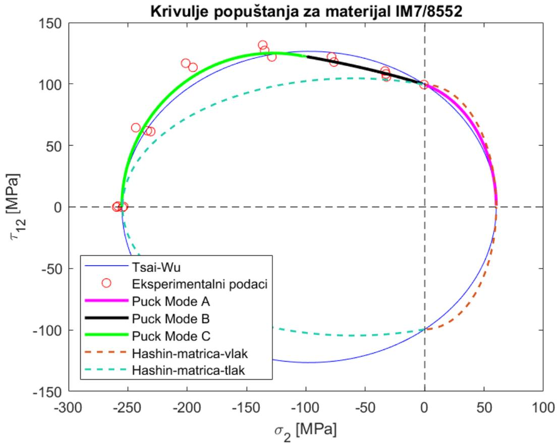
**Slika 20. Krivulje popuštanja u ravнини  $\sigma_2 - \tau_{12}$  za vrijednost smične čvrstoće dobivene biaksijalnim testom**
