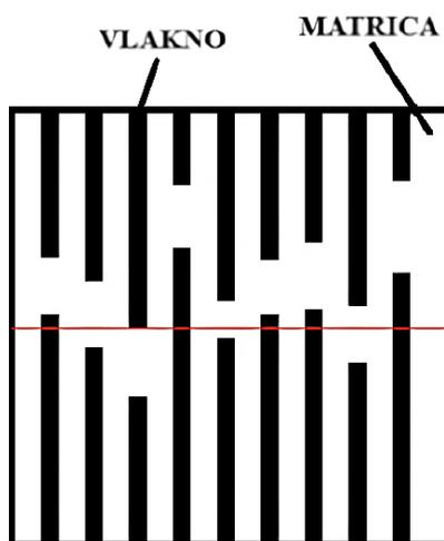
Slika 6. Izvlačenje vlakna
