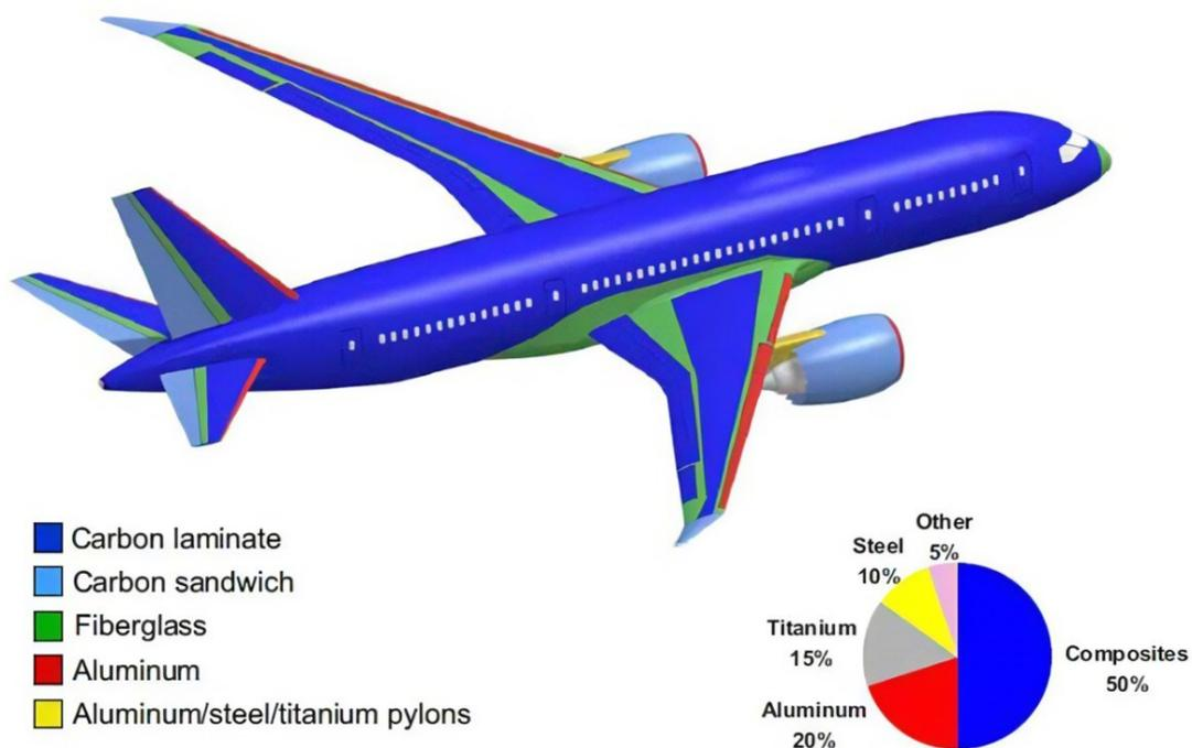
**Slika 2. Konstruktivni materijali zrakoplova Boeing 787 Dreamliner [2]**
