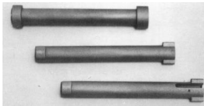
Slika 26. Stadiji izrade zatvarača
