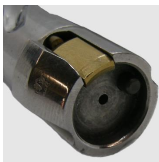
Slika 31. Sako kit u zatvaraču
