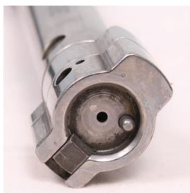
Slika 23. Glava zatvarača mehanizma guranja
