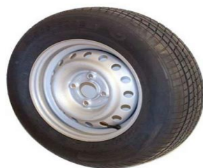
Slika 29. Kotač sa gumom 155/70 R13 [5]
