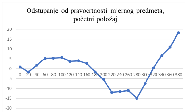
Slika 17. Odstupanje od pravocrtnosti mjernog predmeta, početni položaj
