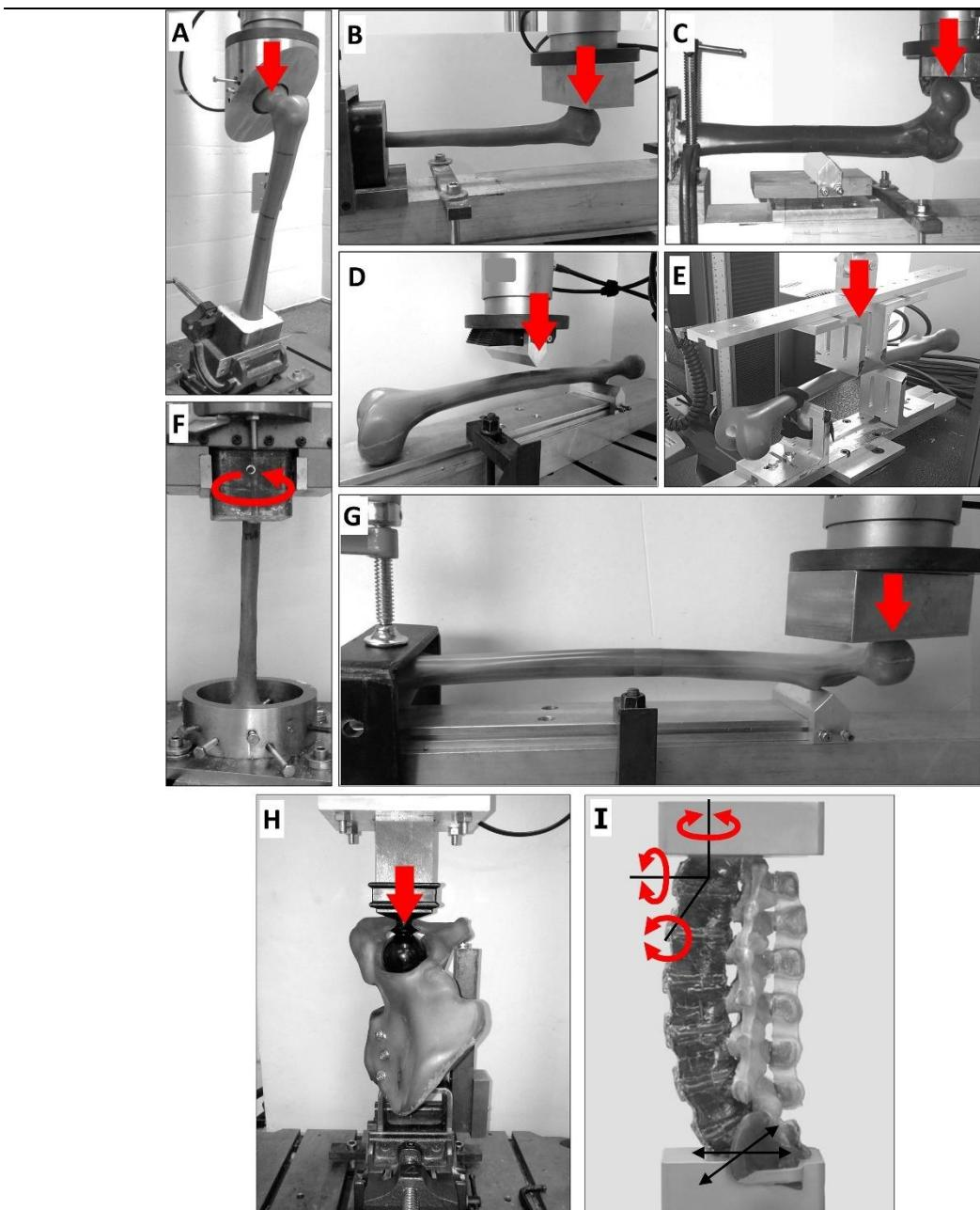
Slika 2.10. Tipični načini opterećenja za ispitivanje kompozitnih kosti [6]
