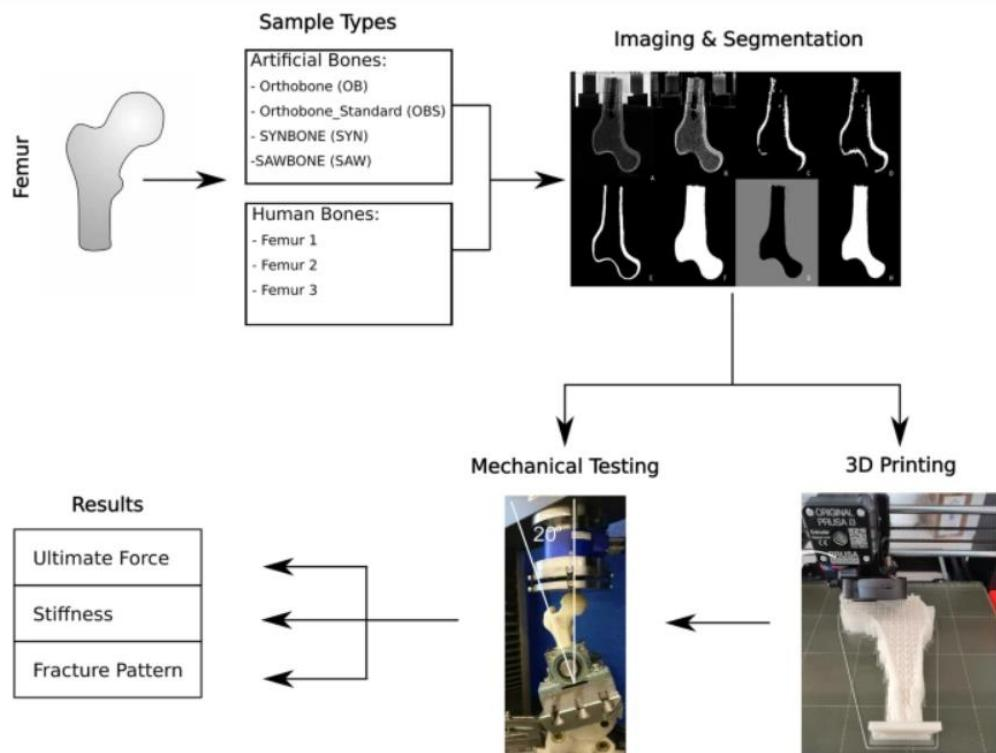
Slika 2.1. Tijek rada ispitivanja razlika između komercijalno dostupnih, 3D tiskanih i ljudskih kostiju [2]
