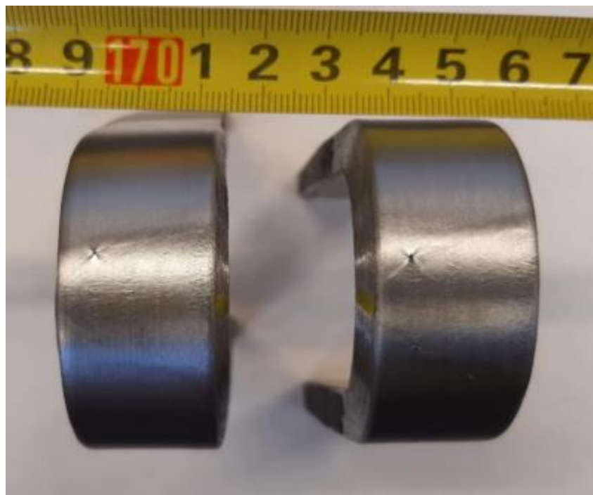
Slika 22. Uzorci nakon ispitivanja bočnog savijanja [21]
