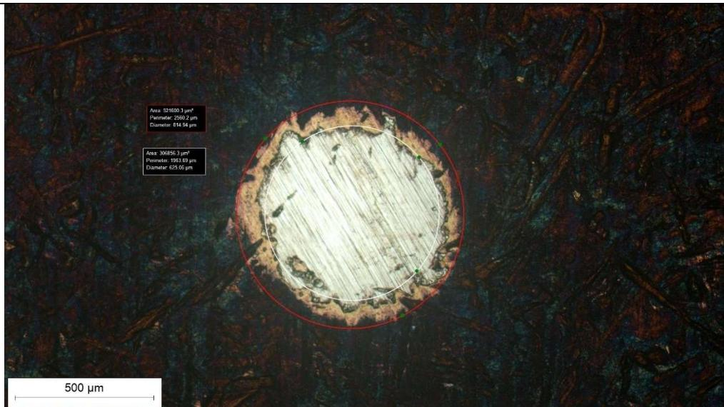
Slika 37: Promjer i površina za uzorak C
