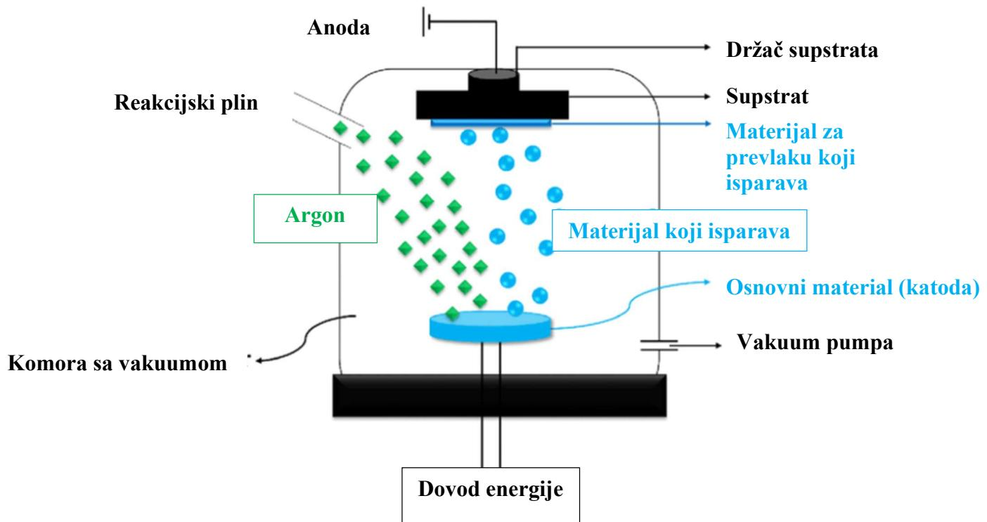
Slika 6: Shematski prikaz uređaja za PVD postupak [12]
