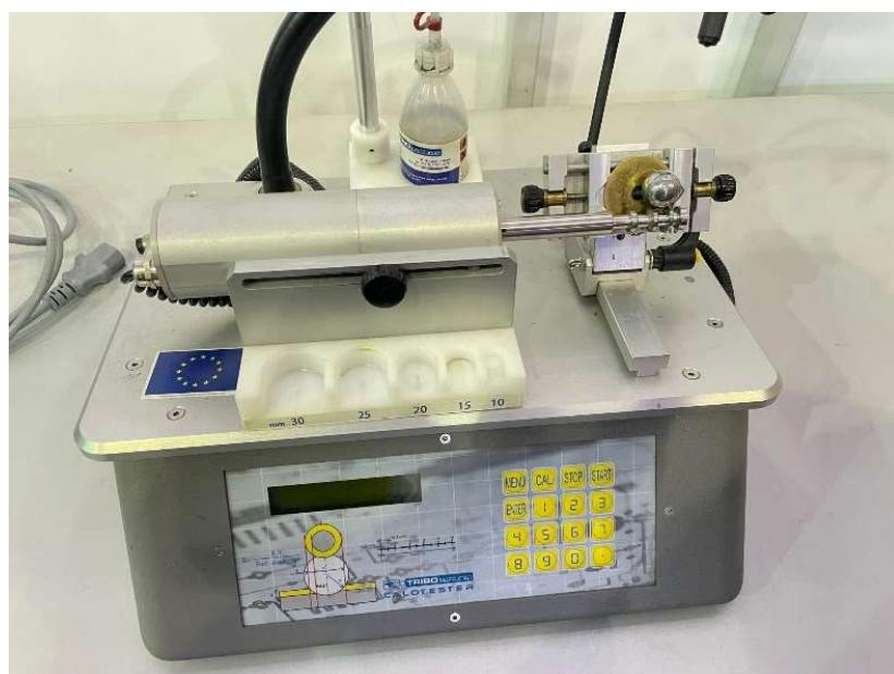
**Slika 25: Kalotester TRIBOtechnic korišten za određivanje mikroabrazivskog trošenja TiN**
