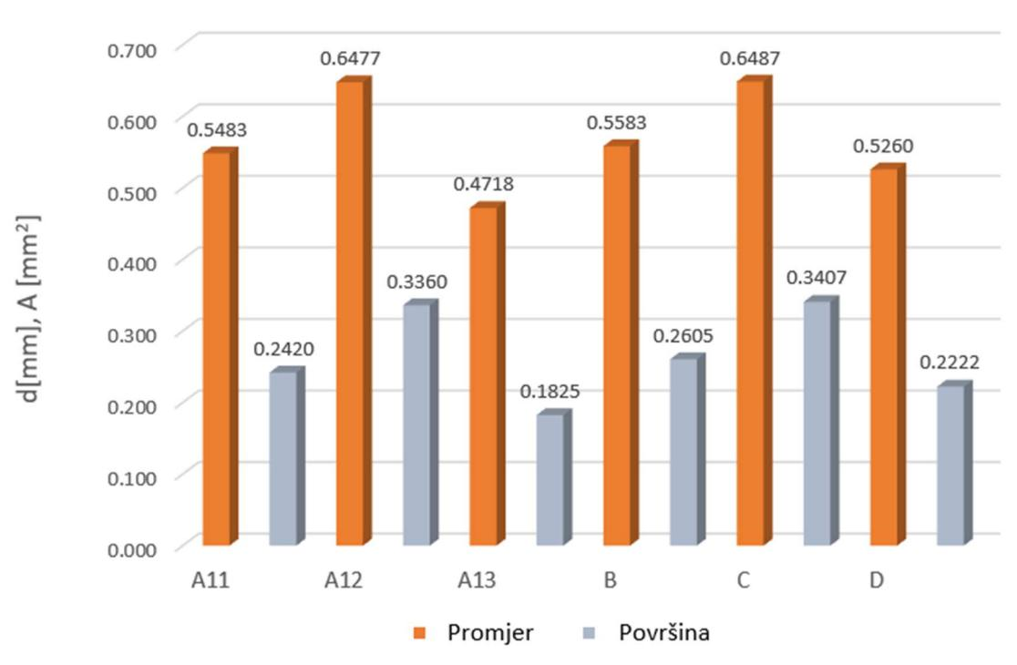
**Slika 32: Usaporedba srednjih vrijednosti promjera i površina kalota za sve ispitne uzorke**
