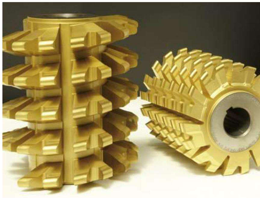
**Slika 12:** Odvalno glodalo prevučeno TiN prevlakom [18]
