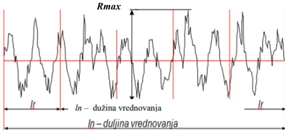
Slika 15: Parametar  $R_{max}$  [19]
