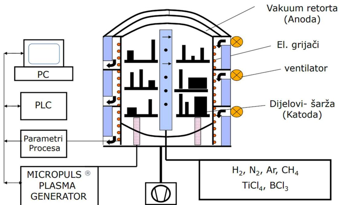
Slika 8: Shematski prikaz PACVD postupka [13]
