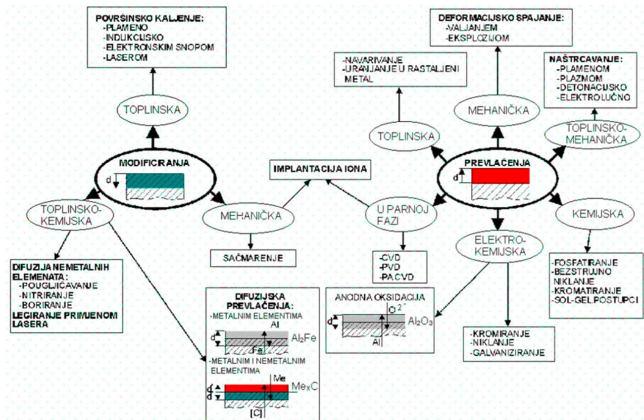
Slika 5: Pregled postupaka modificiranja i prevlačenja površine [10]
