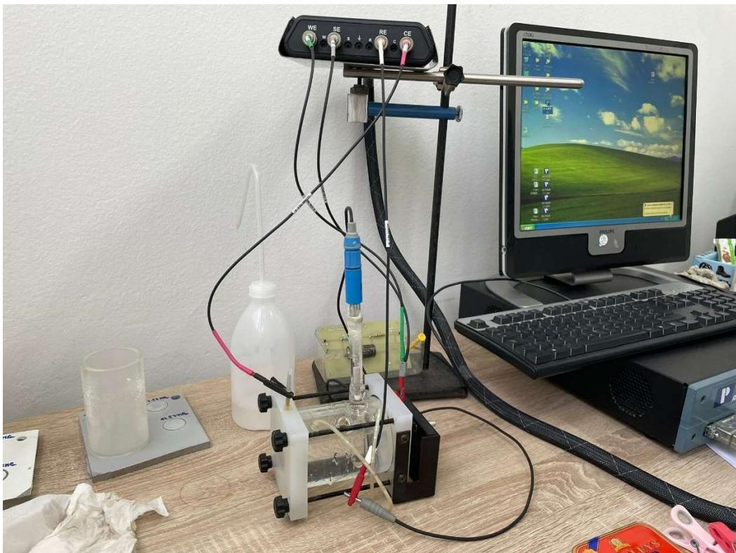
Slika 49: Ispitni uzorak uronjen u elektrolit i ispitivan u elektrokemijskoj ćeliji
