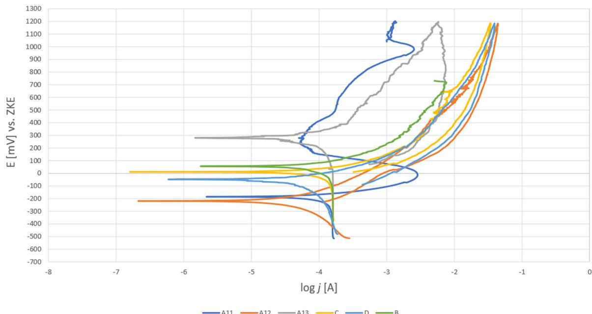
Slika 51: Dijagrami cikličke polarizacije ispitnih uzoraka u 3,5 % otopini NaCl
