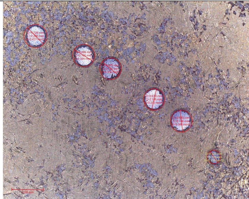
Slika 27: Tragovi trošenja ispitivanja otpornosti na mikroabrazijsko trošenje uzorka A12
