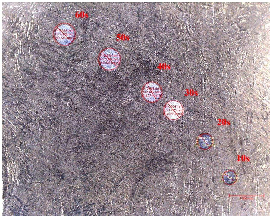
**Slika 26:** Tragovi trošenja ispitivanja otpornosti na mikroabrazivsko trošenje uzorka A11
