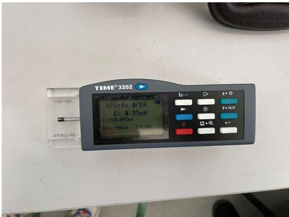
Slika 40: Provjera točnosti uređaja sa etalonom hrapavosti
