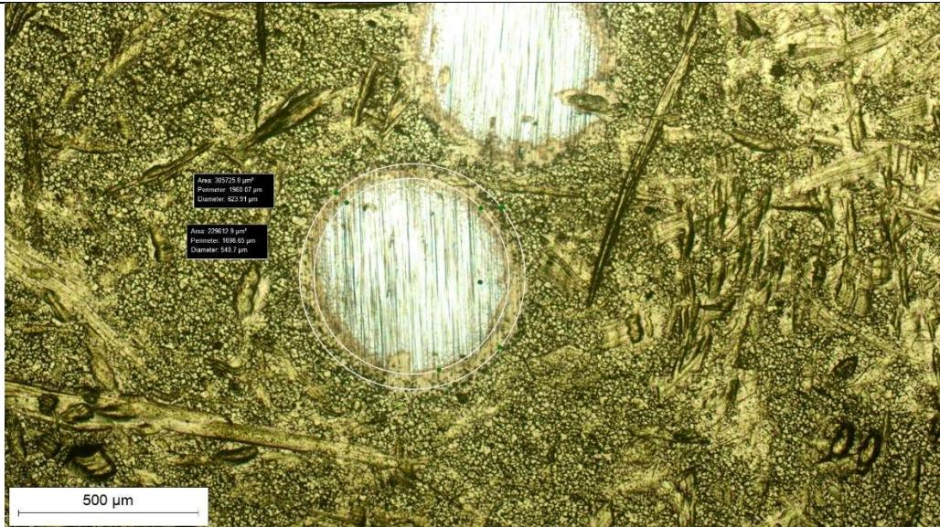
Slika 35: Promjer i površina za uzorak A13
