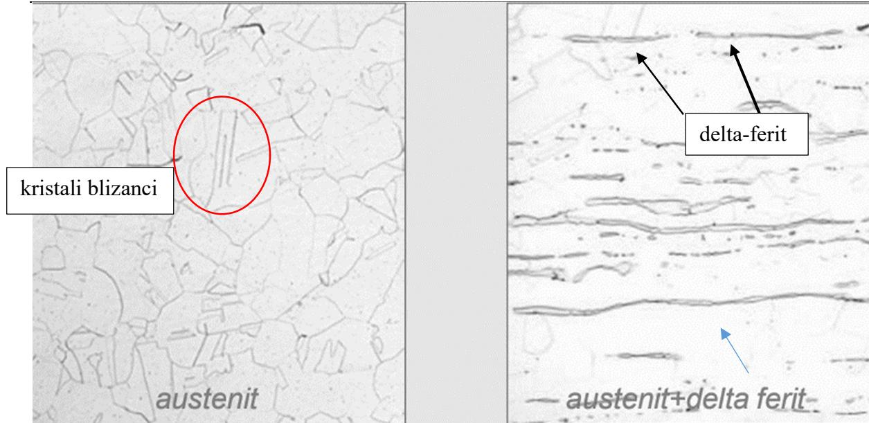
**Slika 2: Moguće mikrostrukture austenitnih nehrđajućih čelika [3]**
