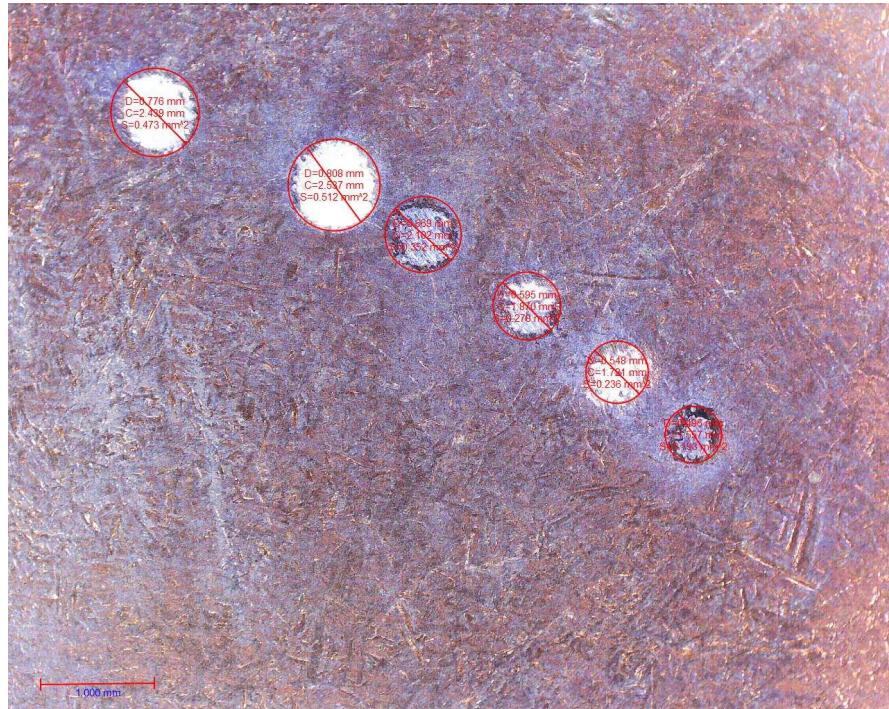
Slika 30: Tragovi trošenja ispitivanja otpornosti na mikroabrazijsko trošenje uzorka C
