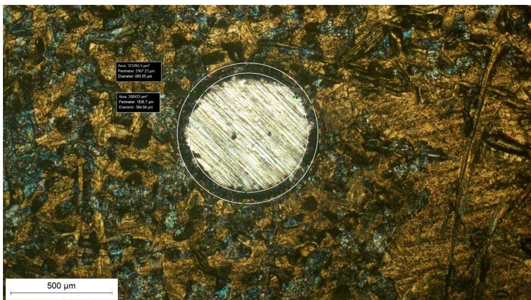
Slika 34: Promjer i površina za uzorak A12
