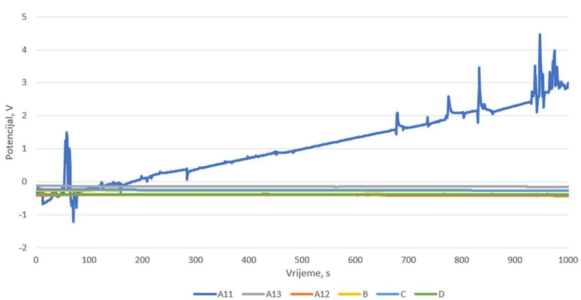
Slika 50: Rezultati ispitivanja elektrokemijskog potencijala za sve ispitne uzorke
