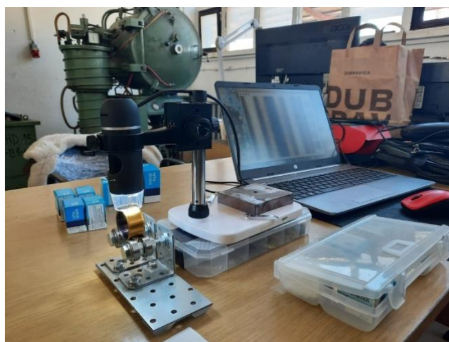
Slika 33. Analiza površine uzoraka primjenom svjetlosnog mikroskopa s kamerom
