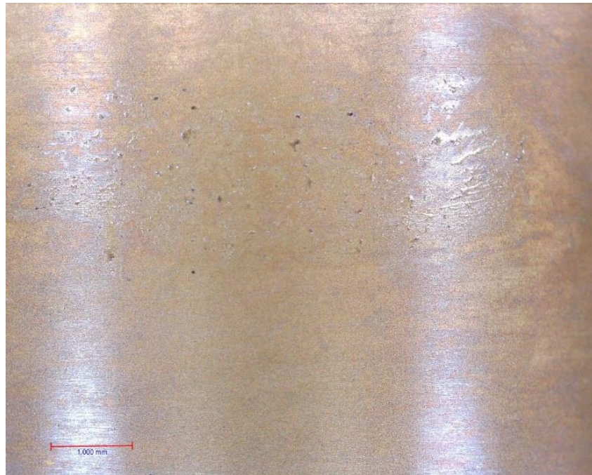
Slika 36. Površina prstena P2 s prevlakom PACVD TiN nakon 15 min trošenja
