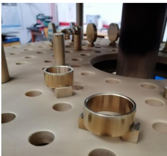
Slika 7. Prstenovi igličastog ležaja nakon prevlačenja prevlakom PACVD TiN
