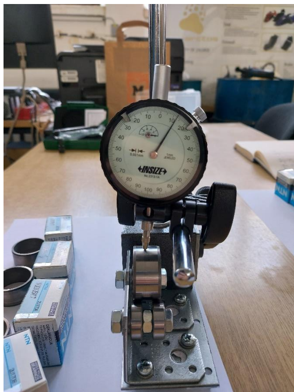
Slika 30. INSIZE Uređaj za mjerenje odstupanja od kružnosti
