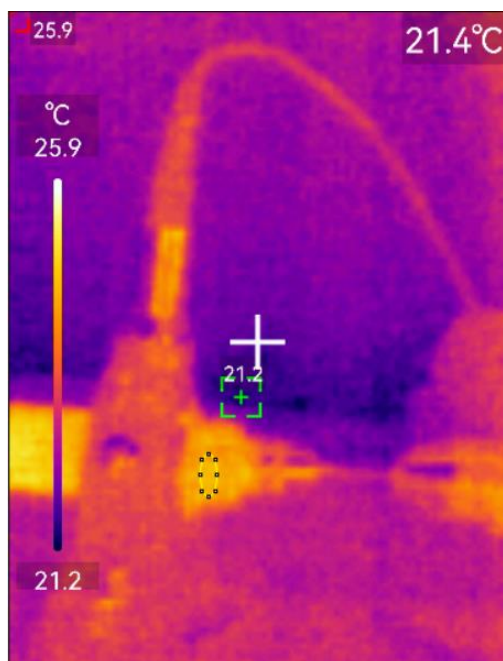
Slika 52. Prsten PN 450/6h fotografiran termokamerom pri 1500 okr/min
