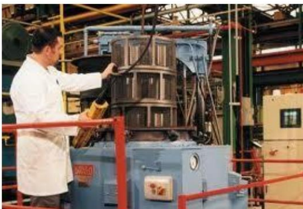
Slika 13. Jamske peći za nitriranje u plinu [11]
