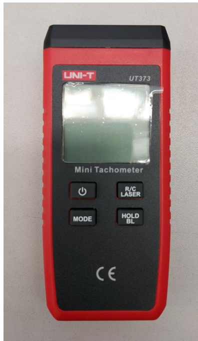
Slika 29. Laserski tahometer UT373
