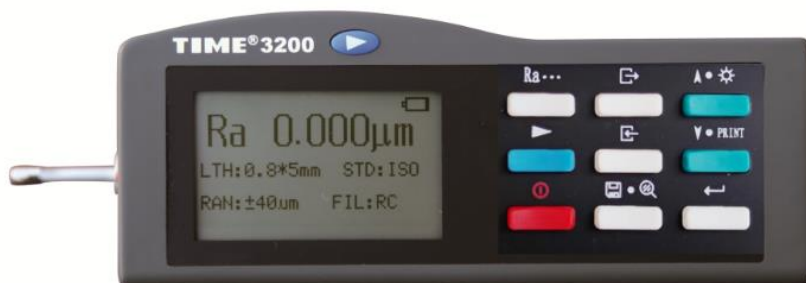
Slika 32. Uređaj za mjerenje hrapavosti TIME 3202
