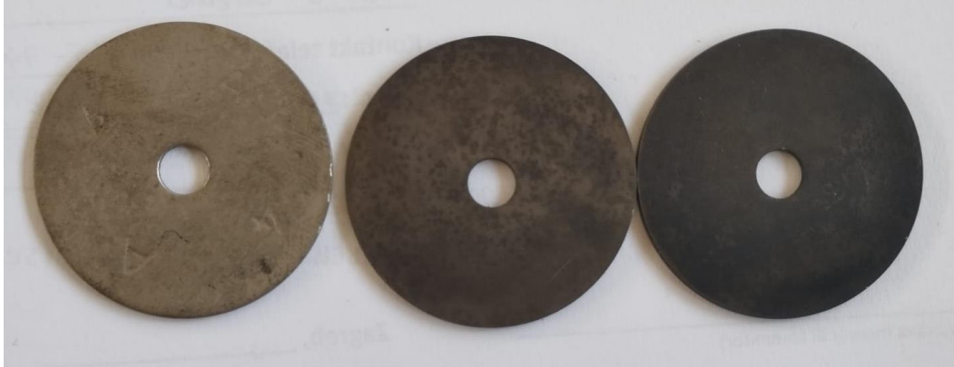
Slika 28. Uzorci od čelika X5CrNiMo17-12-2 nakon boriranja u prašku DURBORID G
