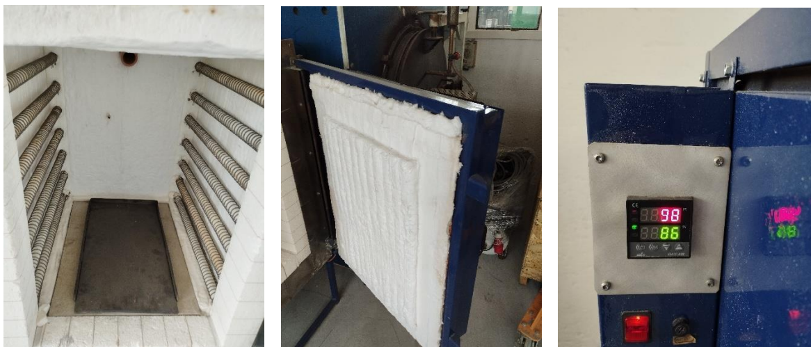
Slika 24. Elektrootporna peć s automatskom regulacijom temperature
