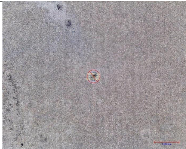
Slika 39. Kalota na uzorku B21 trošenom 10 s
