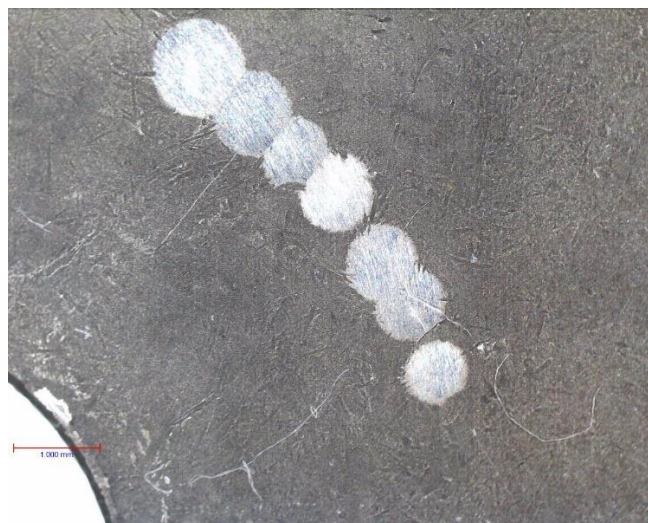
Slika 43. Uzorak B41 trošen 10-90 s
