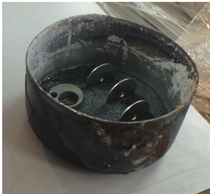
Slika 25. Položaj uzoraka u posudi za boriranje
