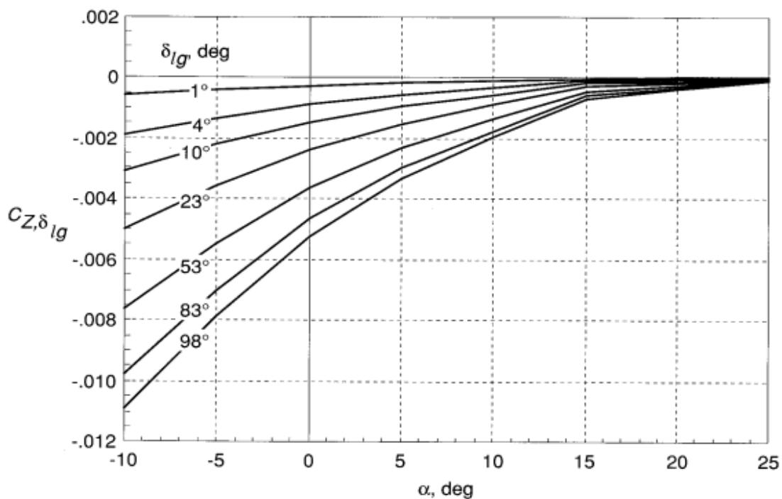
Slika 7. Ovisnost koeficijenta  $C_{Z\delta_{lg}}$  o napadnom kutu  $\alpha$  [3]
