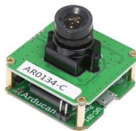
Slika 50. Arducam CMOS AR0134[31]
