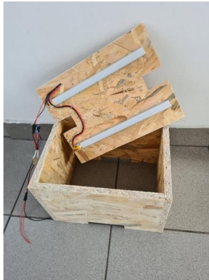
Slika 21. Komora s difuzorima svjetlosti
