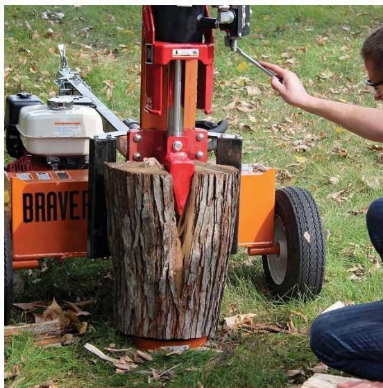
**Slika 3 Hidraulični cjepač**
