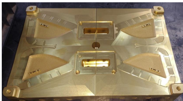
Slika 2.10 Kalup za injekcijsko prešanje polimera s TiN prevlakom
