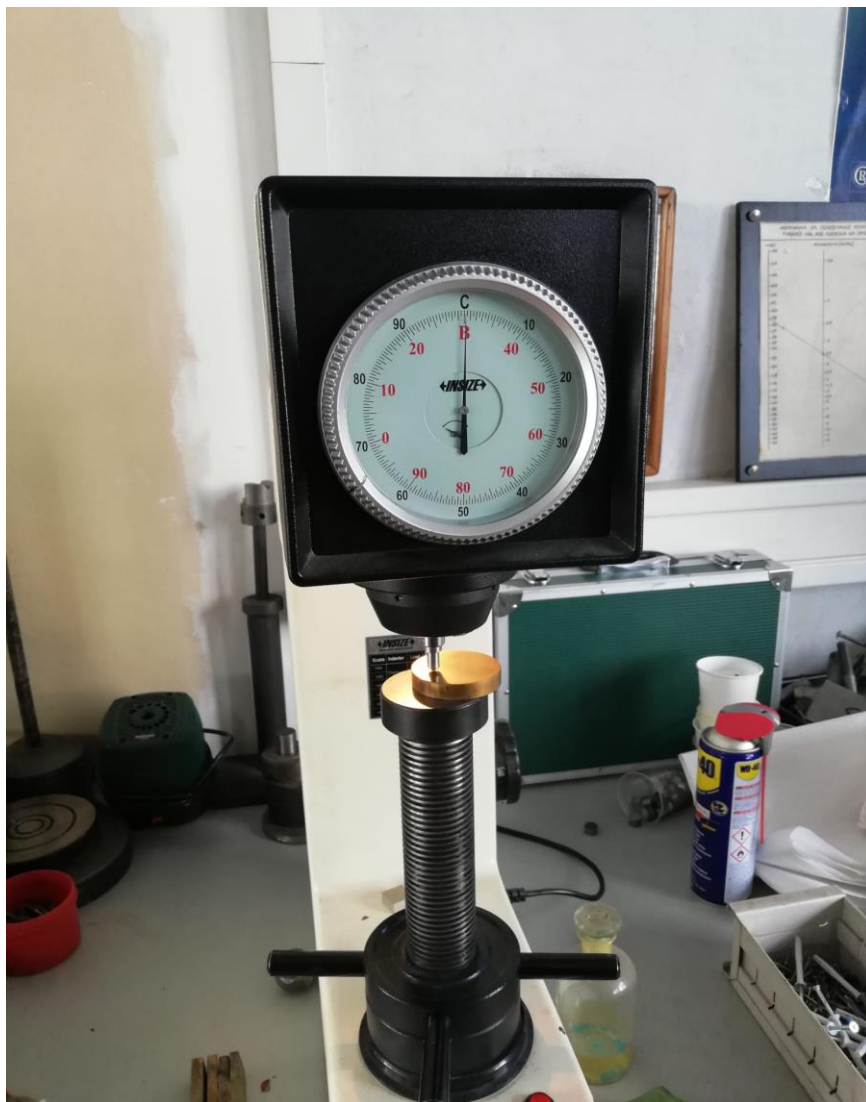
Slika 5.1 INSIZE uređaj za ispitivanje tvrdoće
