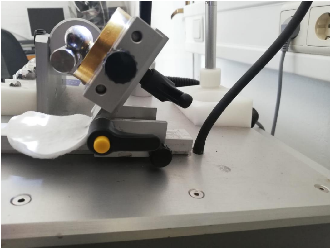
Slika 5.5 Ispitivanje debljine prevlake slobodno rotirajućom kuglom
