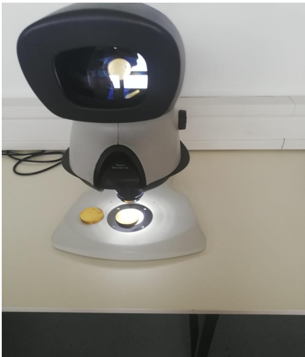
Slika 5.8 Uzorci na stereomikroskopu Mantis Elite Cam-HD
