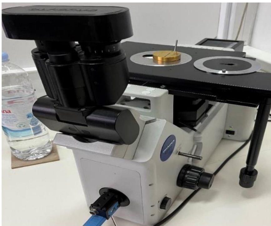
Slika 5.2 Svjetlosni mikroskop Olympus GX51
