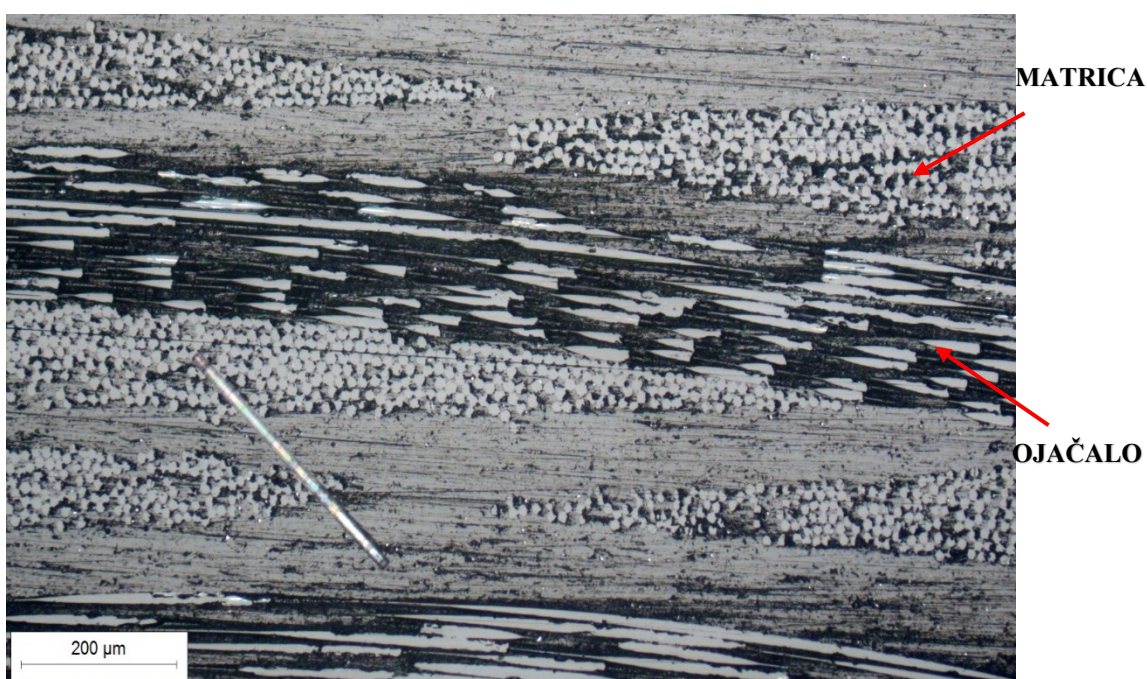
Slika 38. Uzorak U7 pri povećanju 100x
