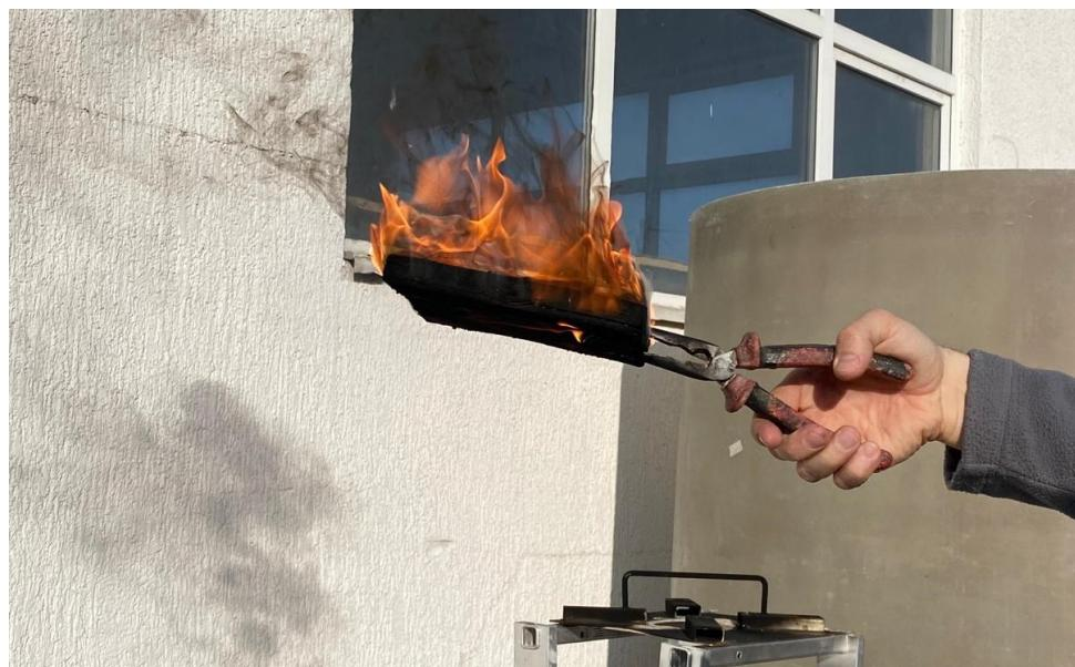
**Slika 18. Uzorak U2 nakon uklanjanja sa plamena**
