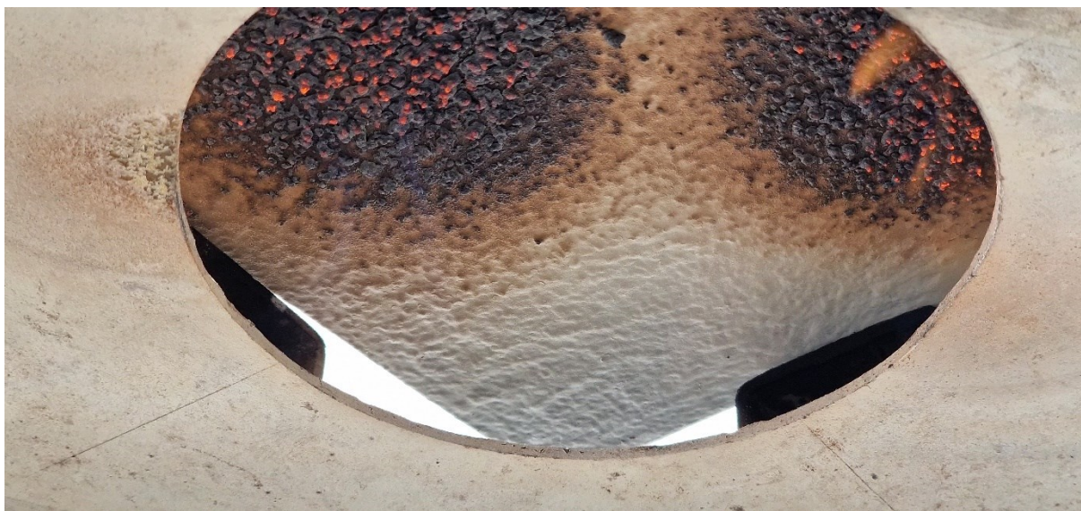
Slika 19. Bubrenje premaza na uzorku U4
