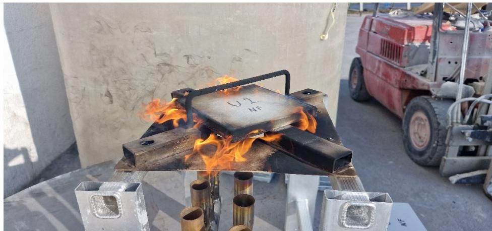
**Slika 17. Uzorak U2 nakon 7 min izlaganja**
