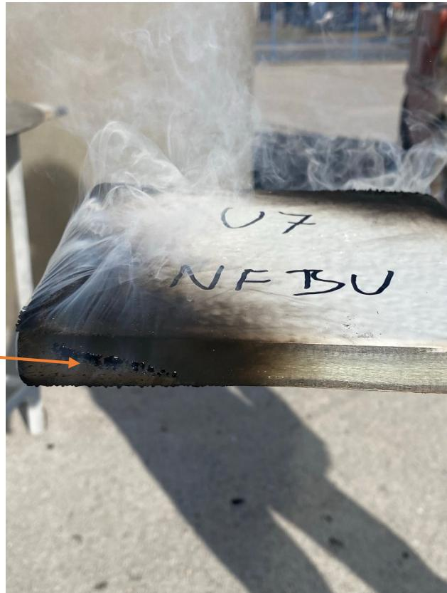
Slika 25. Zapaljenje bočnih stranica uzorka U7
