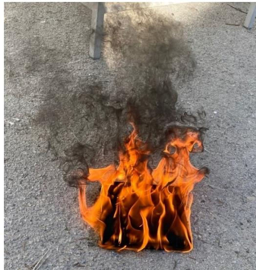
**Slika 15. Uzorak U1 nakon sklanjanja sa plamena**
