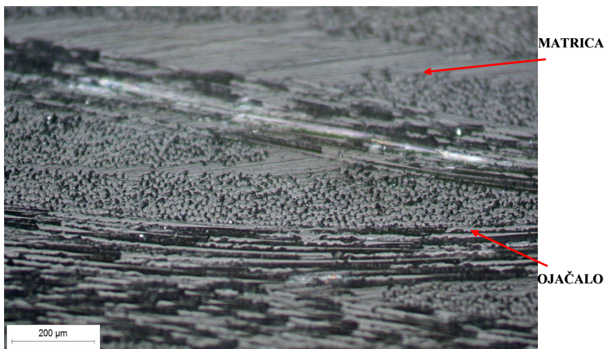
Slika 34. Uzorak U2 pri povećanju 100x
