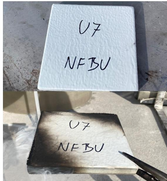
Slika 24. Uzorka U7 nakon uklanjanja sa izvora plamena
