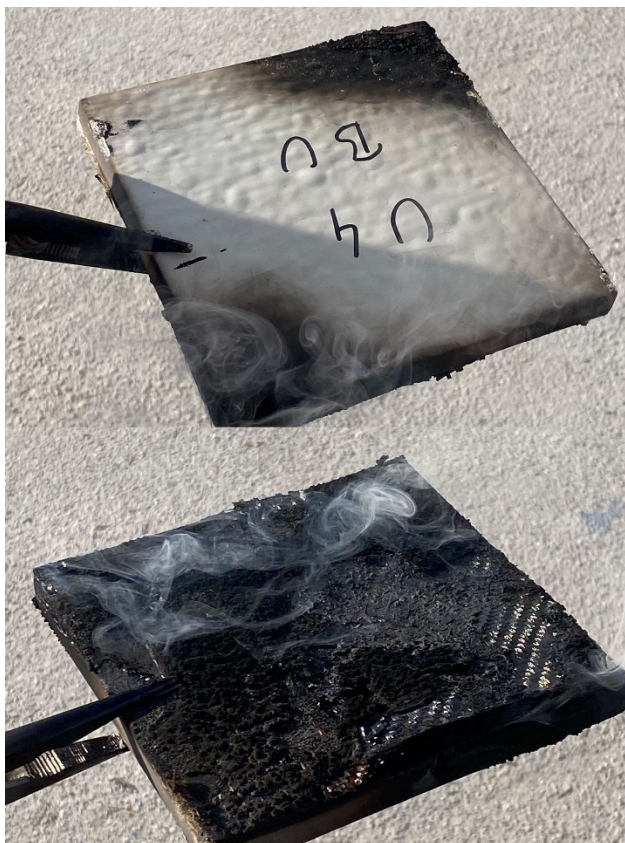
Slika 22. Uzorak U4 nakon skidanja sa izvora plamena
