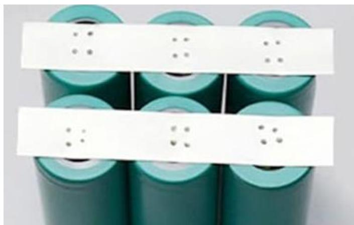
Slika 35 Točkasto zavarene li-ionske čelije
