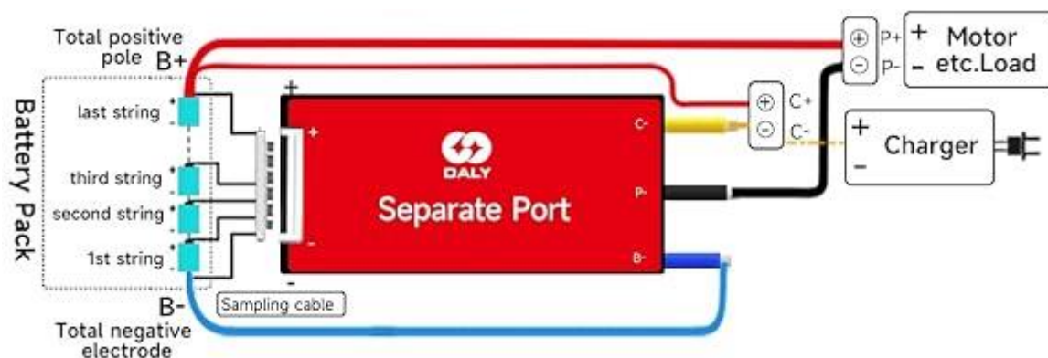
Slika 36 Način spajanja BMS-a
