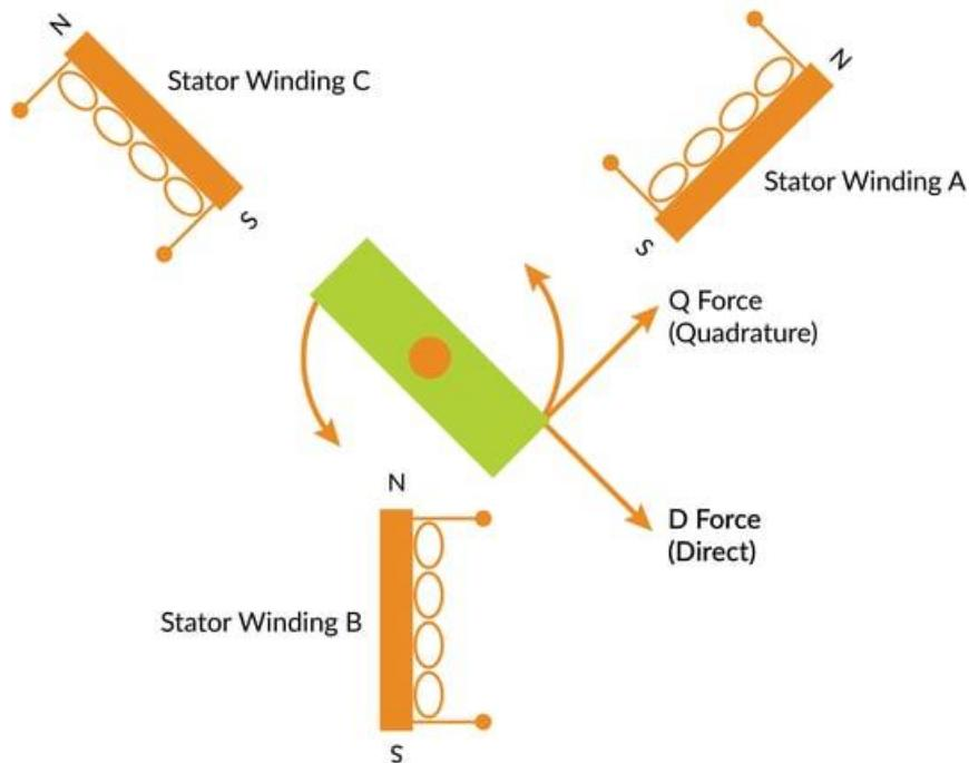
Slika 19 Vektori za FOC upravljanje BLDC motora
