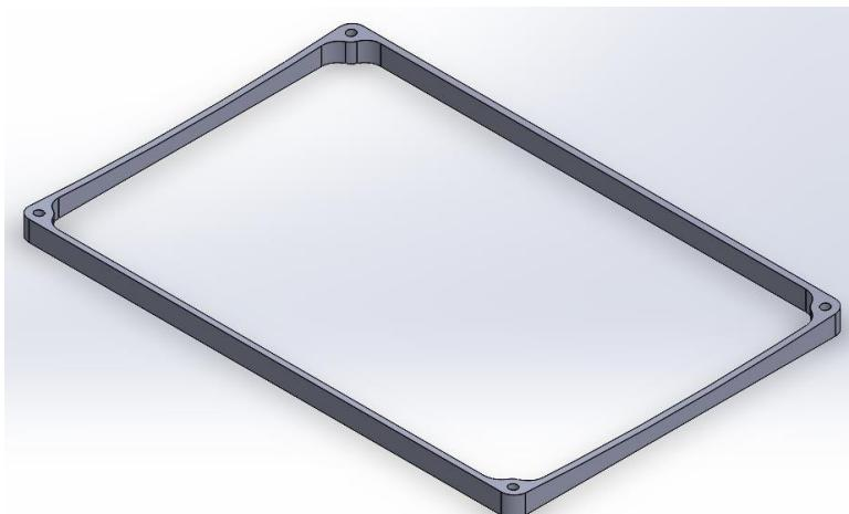
**Slika 46 Odstojnik kućišta**
