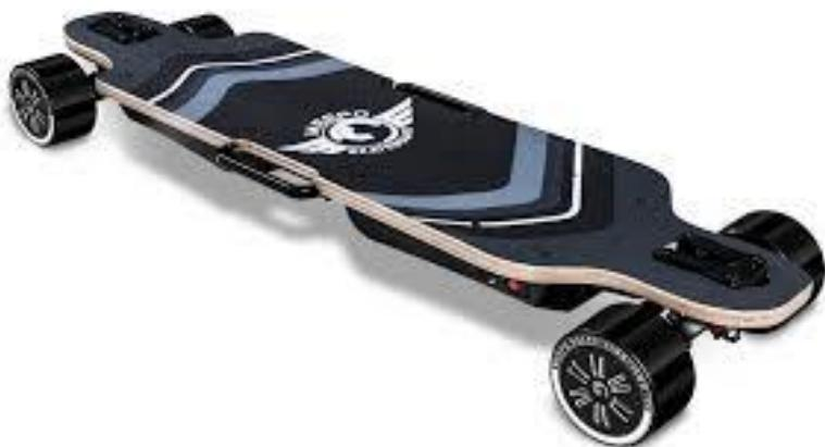
Slika 7 Električni skateboard s direktnim pogonom
