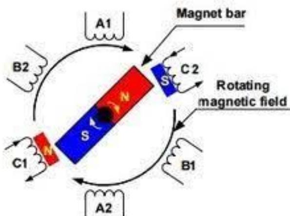
Slika 14 Magnetski polovi BLDC motora
