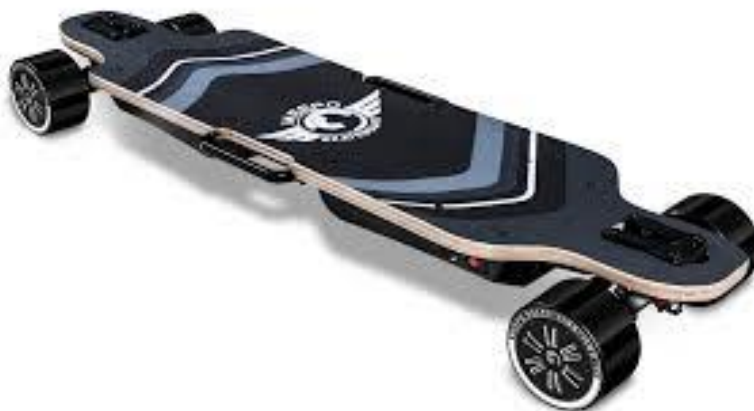
Slika 7 Električni skateboard s direktnim pogonom
