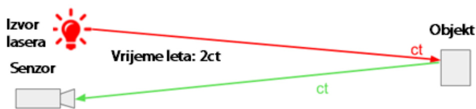
Slika 3. Princip rada TOF metode [5]
