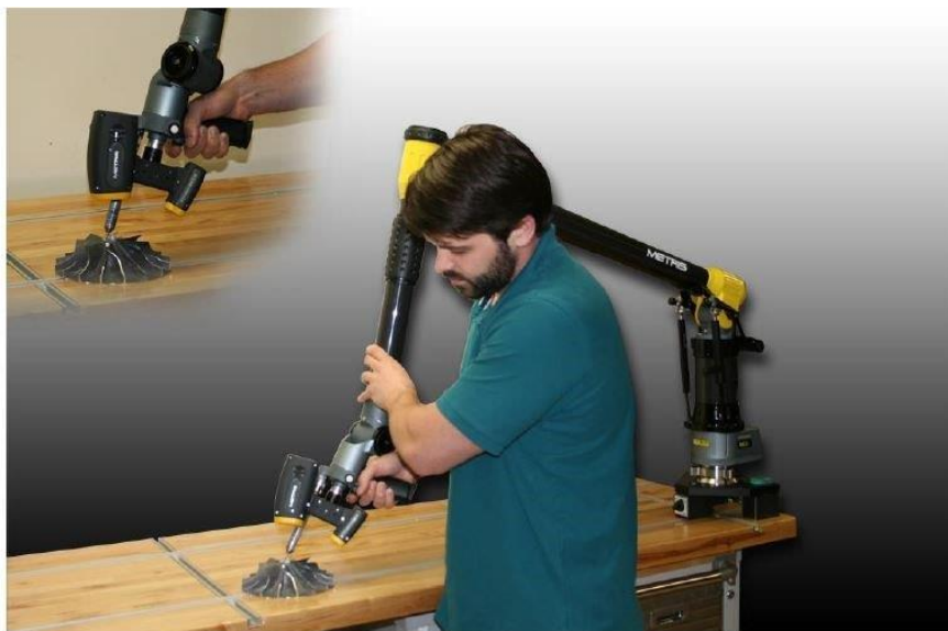
Slika 2. Prikaz rada kontaktne metode [4]
