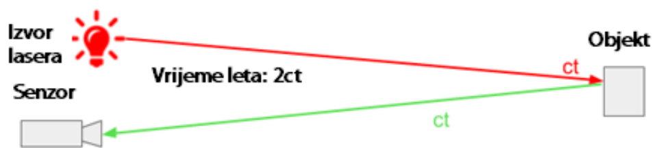
Slika 3. Princip rada TOF metode [5]
