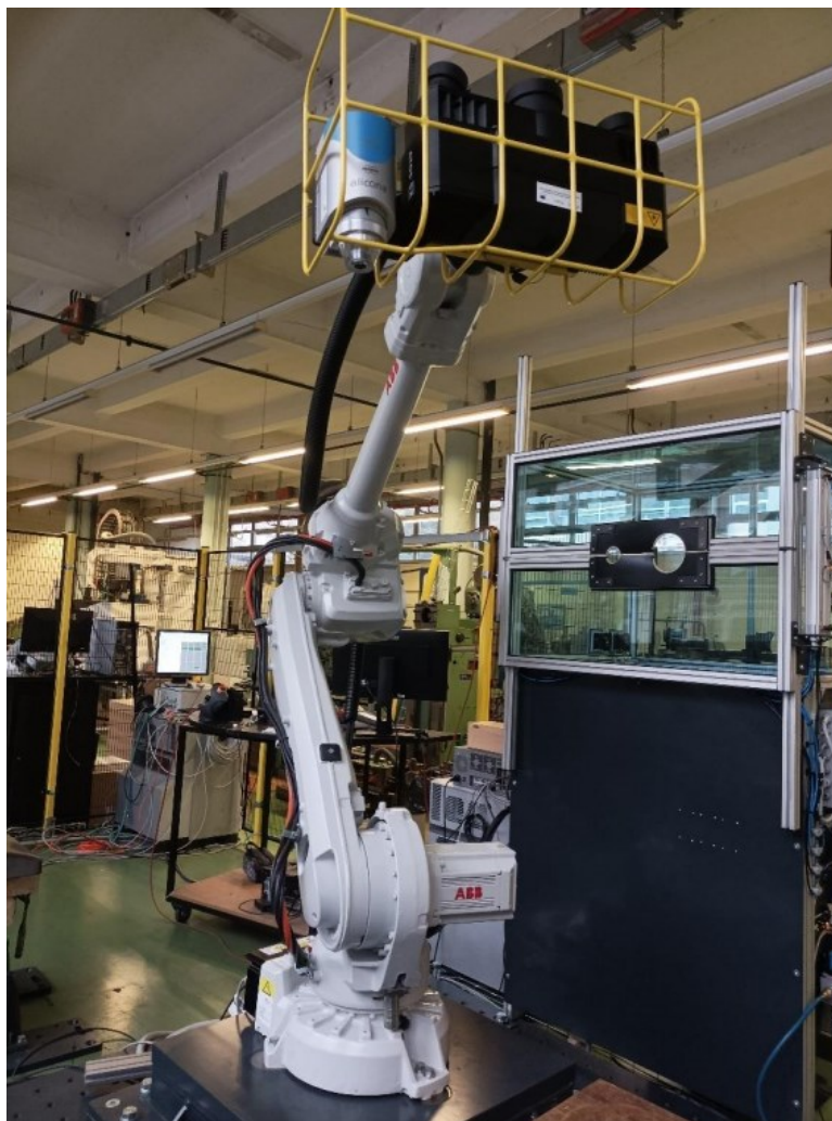
Slika 12. Mjerni uređaj montiran na prihvatnicu robota
