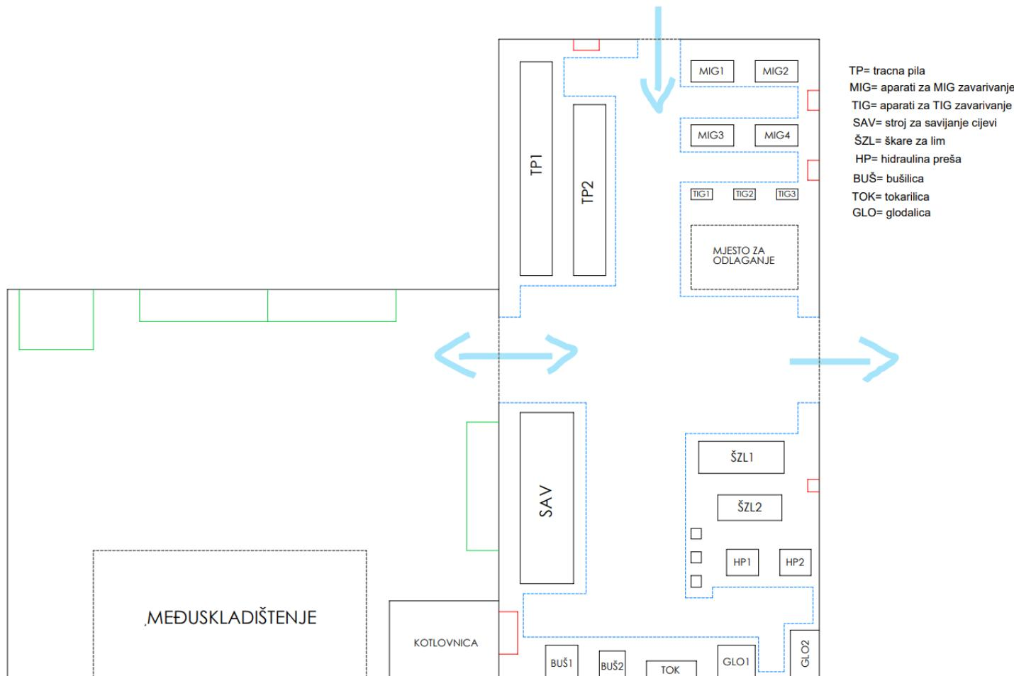
Slika 17. Prikaz i raspored radnih mesta sa strojevima
