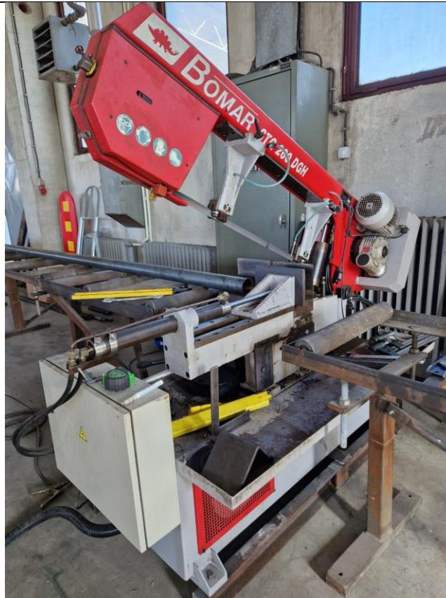
Slika 23. Tračna pila
