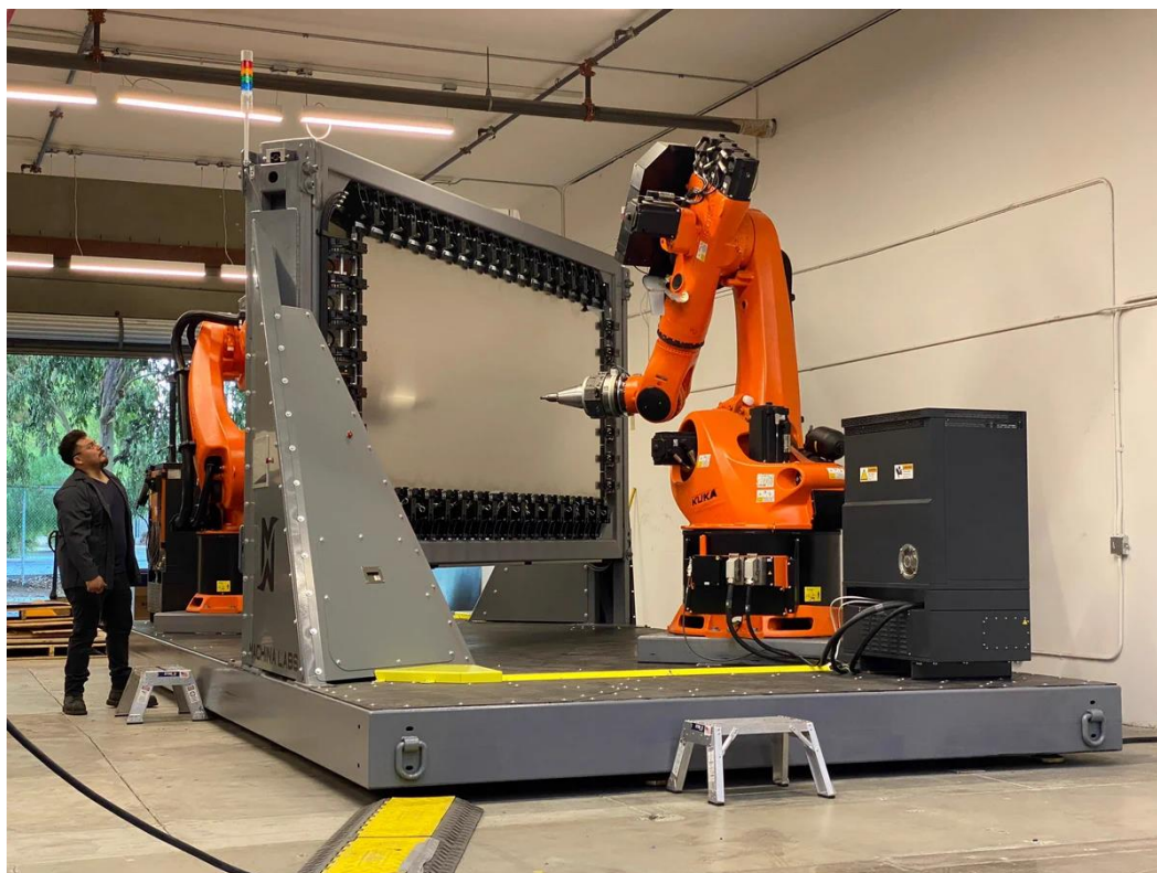
Slika 17. Inkrementalno deformiranje lima pomoću dva robota [13]
