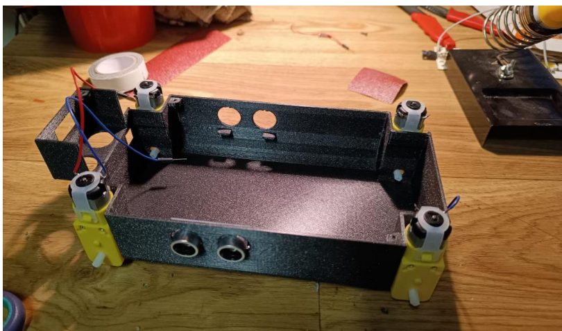
Slika 43. Kućište s postavljenim motorima
