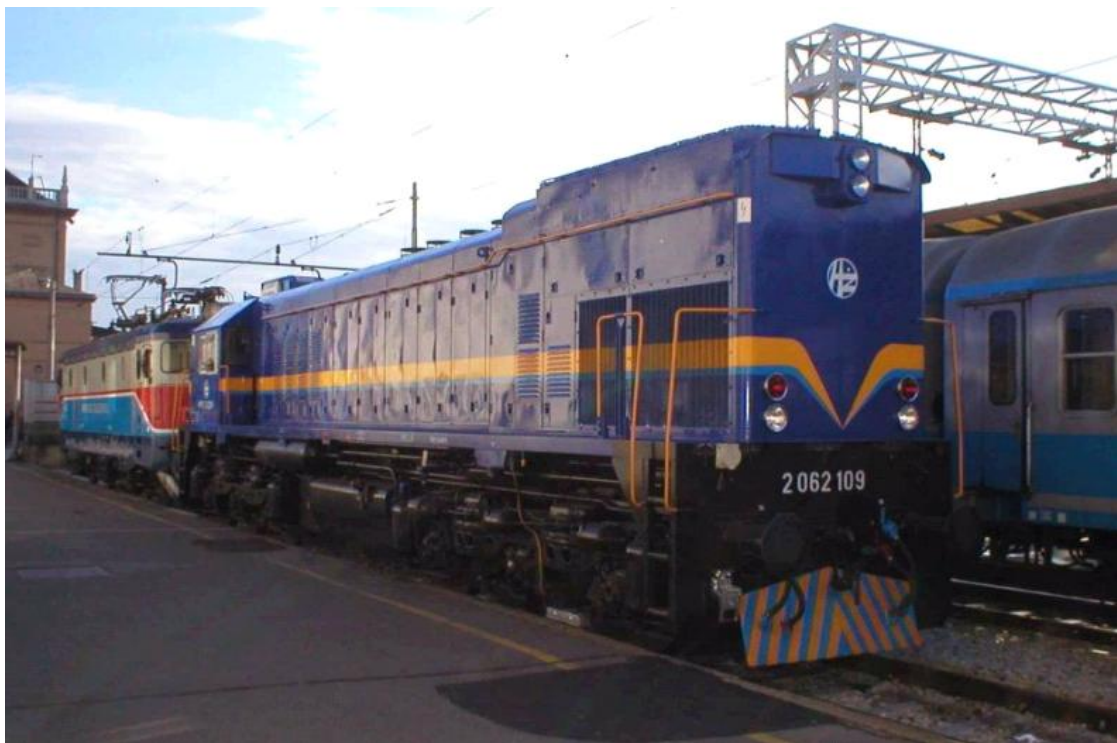
Slika 1. Dizel-električna lokomotiva HŽ serije 2062 100
