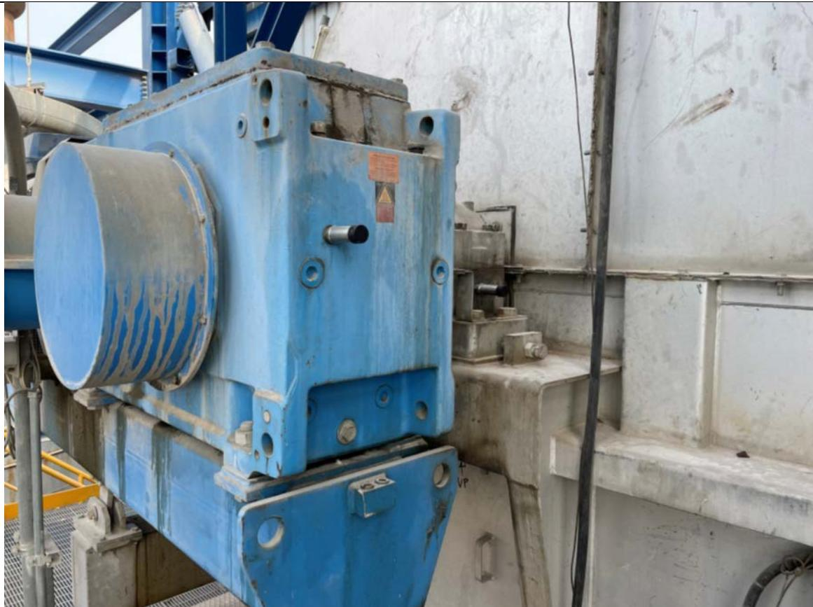
**Slika 37. Montirani senzor na reduktoru glavnog pogona peći [11]**
