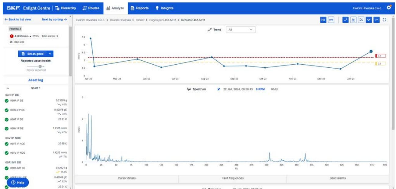
Slika 25. Dijagram trenda mjereneh vibracija za reduktor glavnog pogona peći [11]
