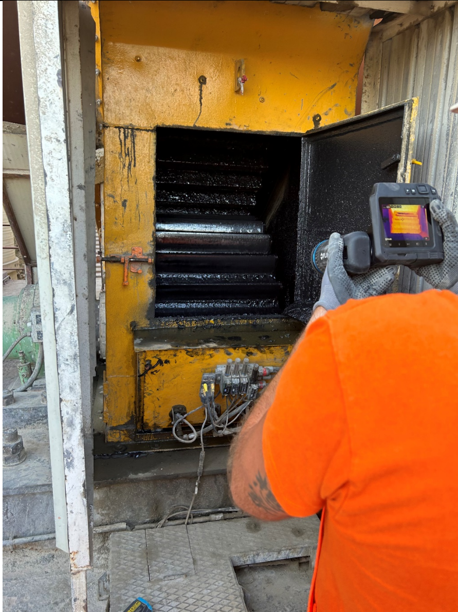
Slika 29. Postupak mjerenja temperature zupčanika rotirajuće peći
