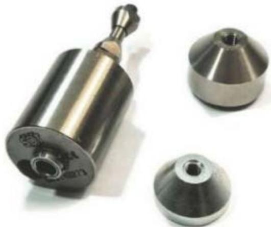
Slika 12. Navojni kontaktni ultrazvučni senzor [13]
