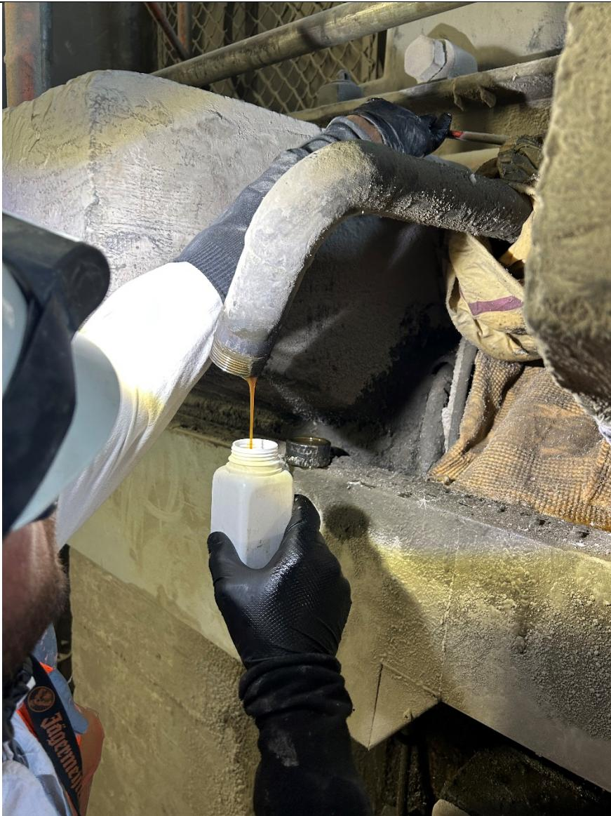
Slika 34. Uzorkovanje ulja s reduktora mlina cementa
