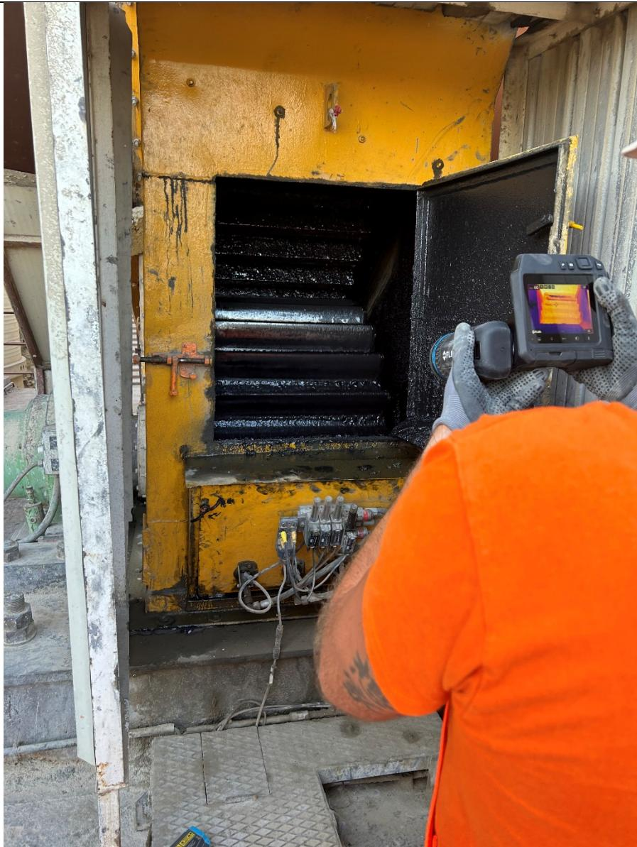
Slika 29. Postupak mjerena temperature zupčanika rotirajuće peći
