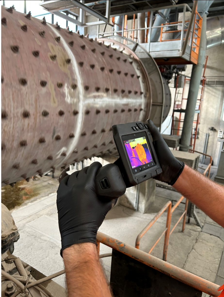
Slika 31. Postupak mjerenja temperature vanjskog ležaja mlina ugljena
