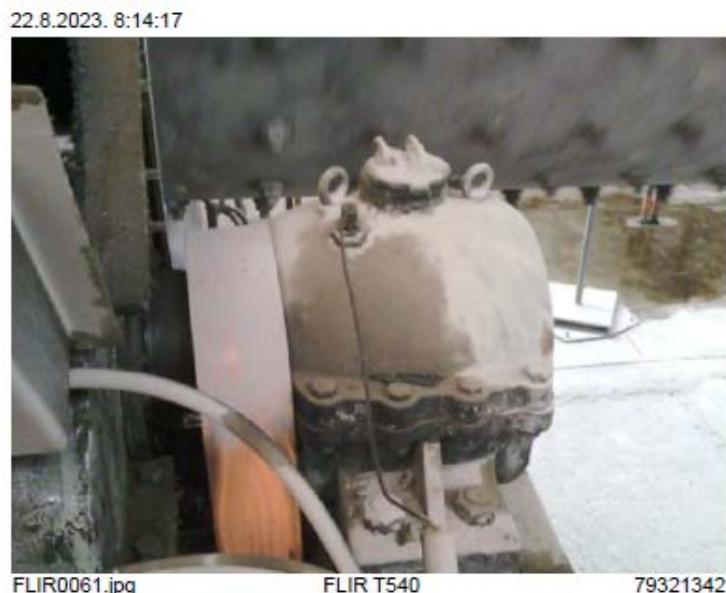
Slika 32. Izvještaj mjerena temperature vanjskog ležaja mlina ugljena
