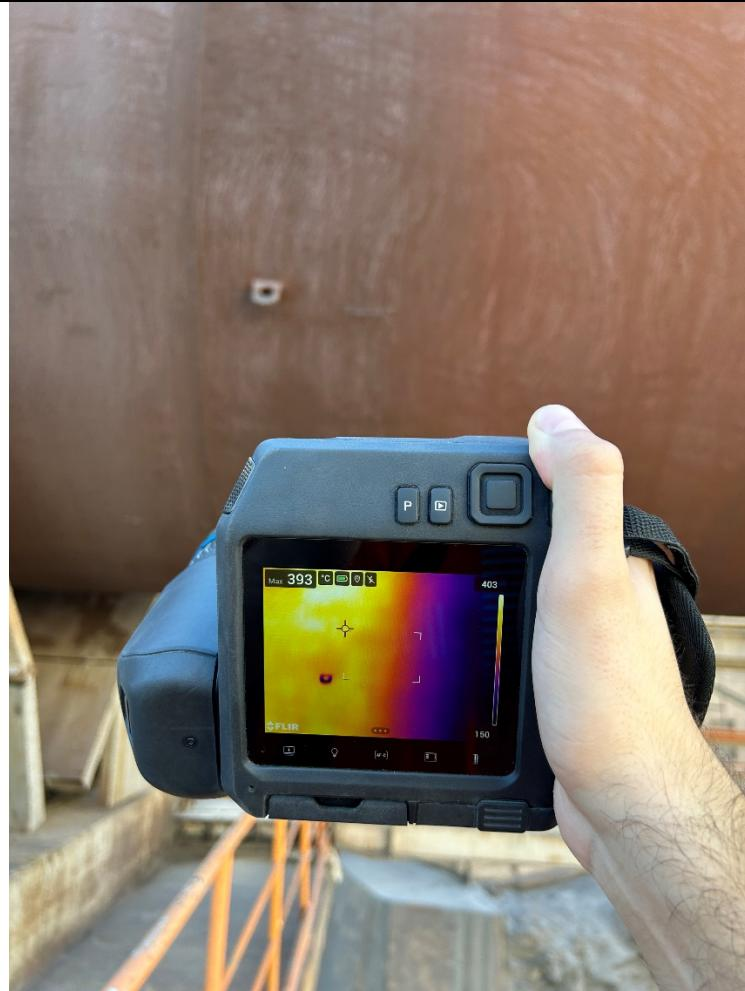
Slika 28. Postupak mjerjenja temperature plašta rotirajuće peći
