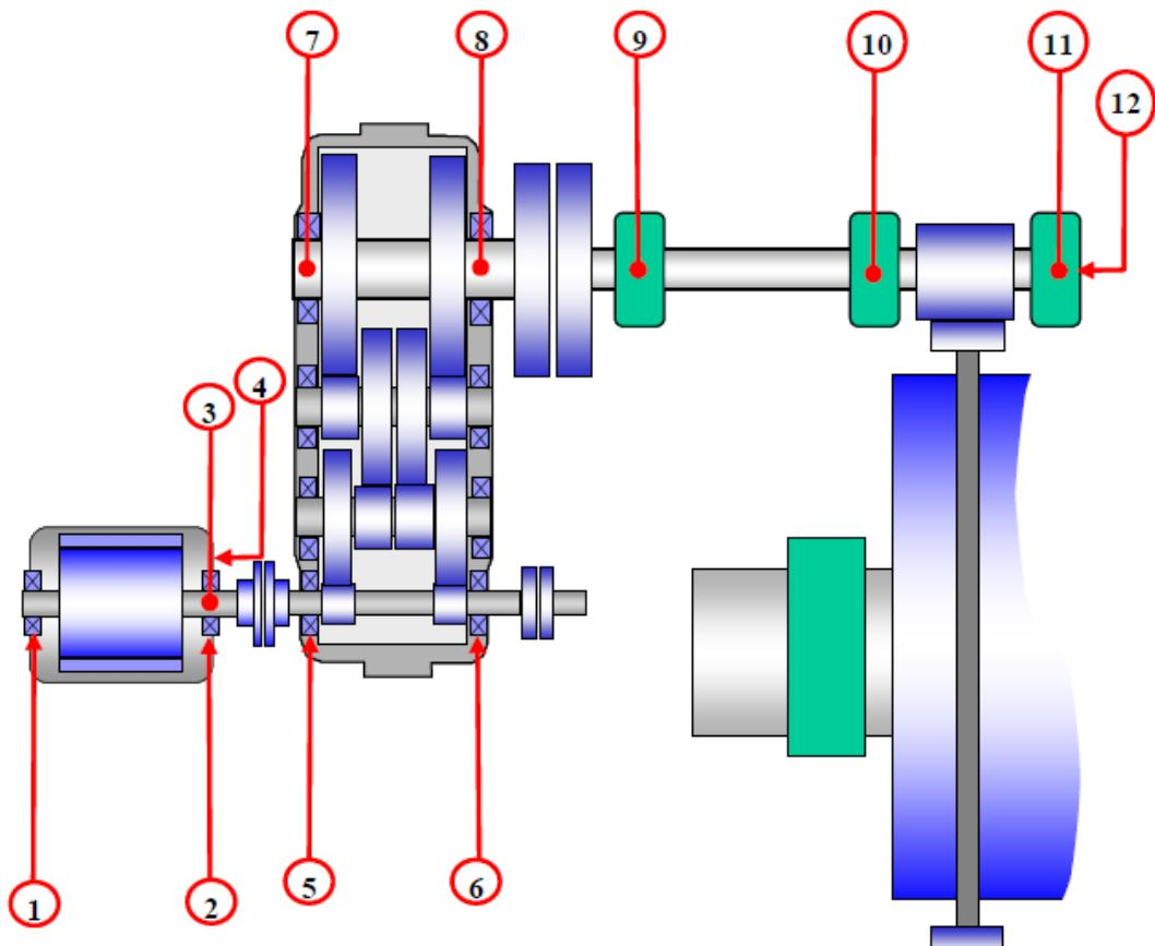
Slika 22. Skica glavnog pogona rotirajuće peći s lokacijama mjerjenja vibracija [11]
