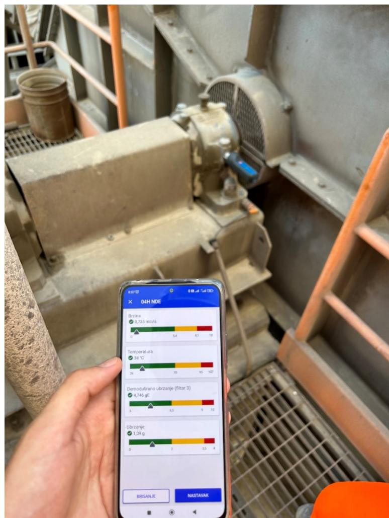
Slika 20. Mjerenje vibracija ležajeva ventilatora otprašivanja peći
