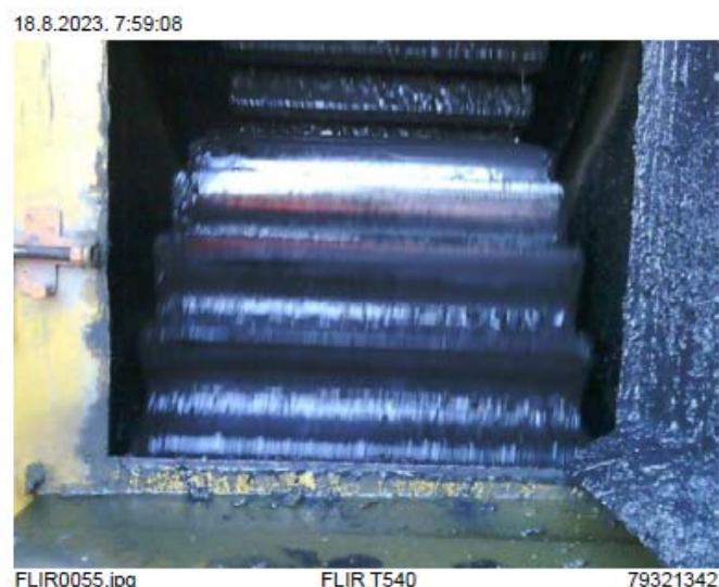
Slika 30. Izvještaj mjerenja temperature zupčanika rotirajuće peći
