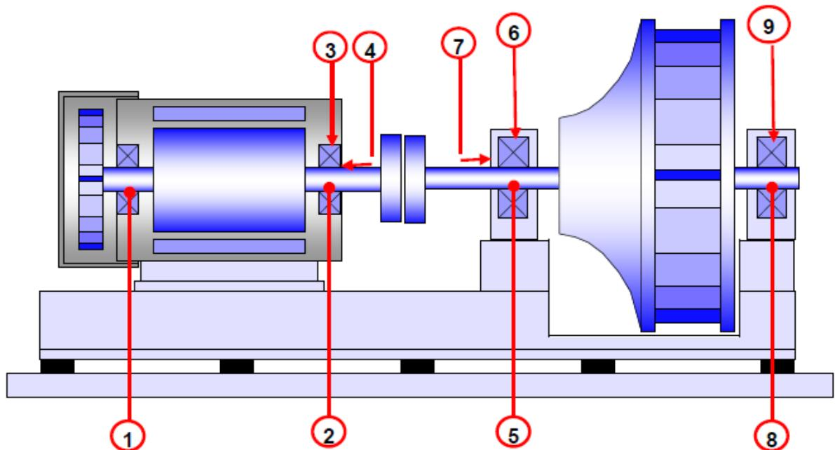
Slika 19. Skica ventilatora s lokacijama mjerena vibracija [11]
