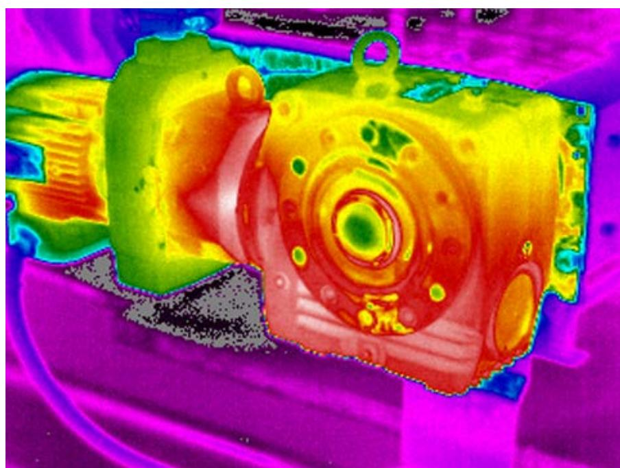
Slika 10. Prikaz termografskog mjerjenja reduktora transportne trake [1]
