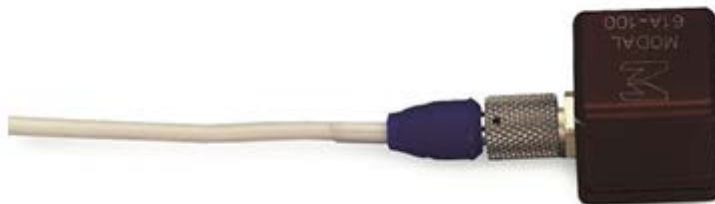
Slika 5. Tipičan oblik akcelerometra za mjerenje vibracija [7]
