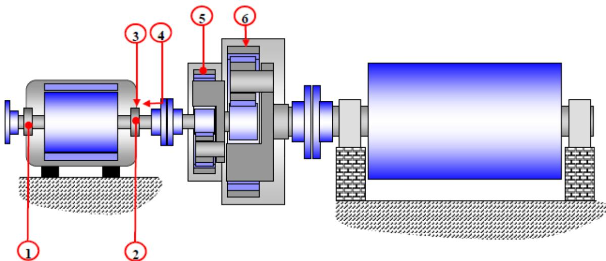
Slika 21. Skica kugličnog mlina s lokacijama mjerena vibracija [11]
