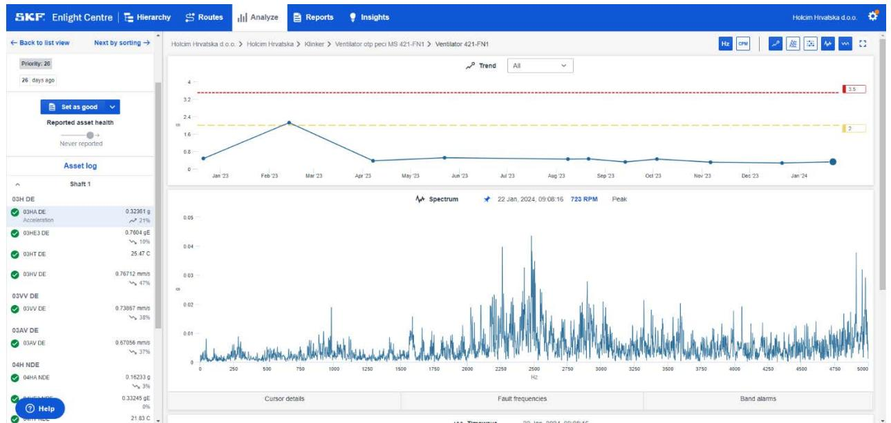
Slika 24. Dijagram trenda mjereneh vibracija za ventilator otprašivanja peći [11]
