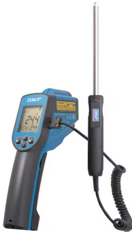
Slika 27. Infracrveni termometar TKTL 30 [19]
