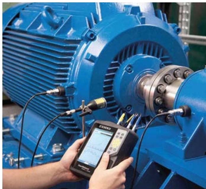
Slika 6. Prikaz mjerena vibracija [7]
