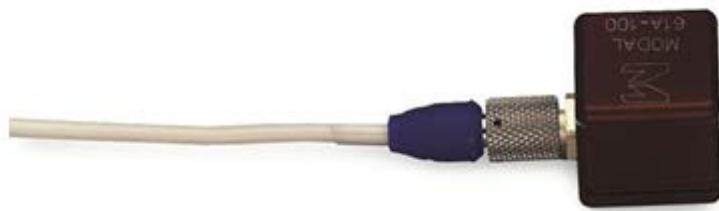
**Slika 5. Tipičan oblik akcelerometra za mjerjenje vibracija [7]**
