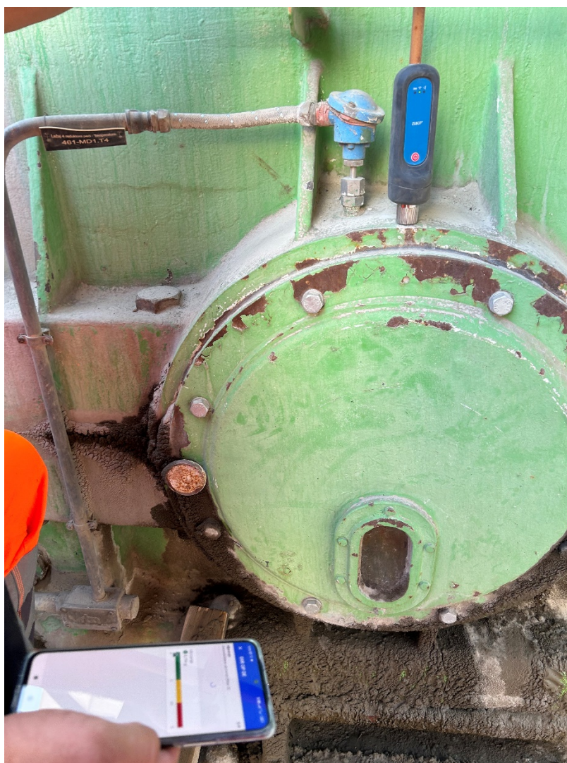
Slika 23. Mjerenje vibracija na reduktoru glavnog pogona peći
