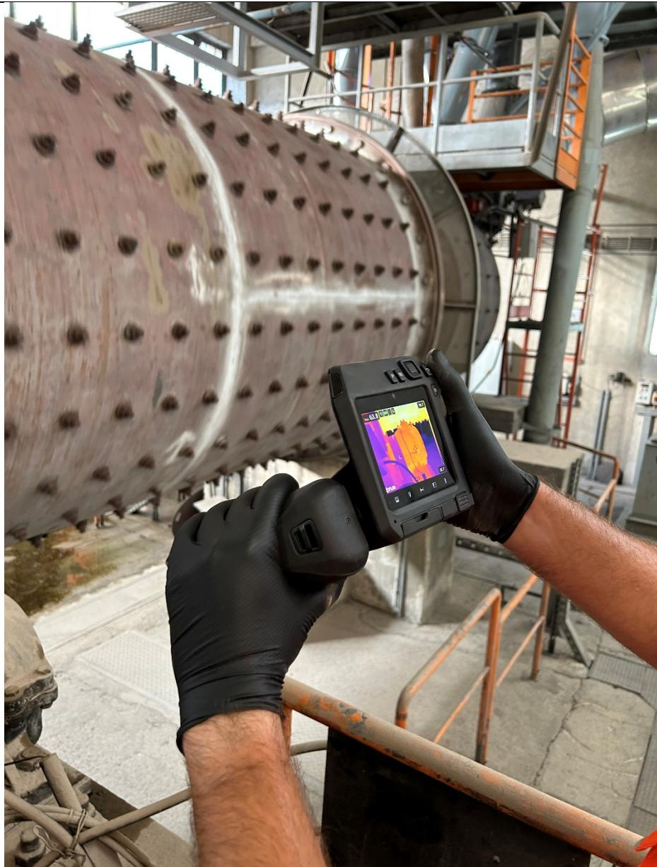
Slika 31. Postupak mjerjenja temperature vanjskog ležaja mlina ugljena
