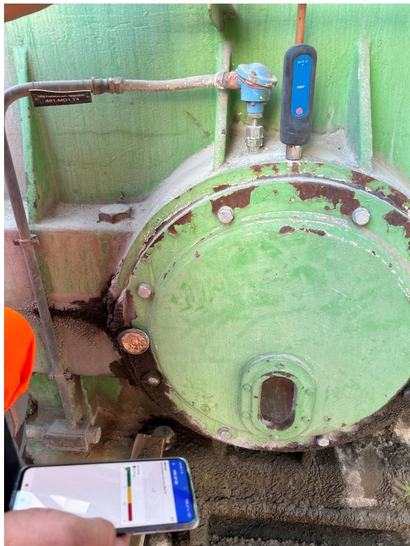
Slika 23. Mjerenje vibracija na reduktoru glavnog pogona peći
