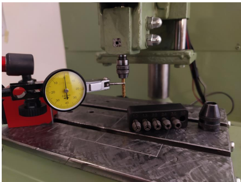
Slika 22. Set Proxxon steznih čahura, brzostezna glava i način mjerenja ekscentričnosti
