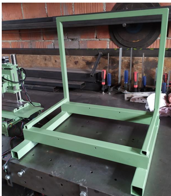
Slika 39. Cijevna zavarena konstrukcija kućišta glodalice
