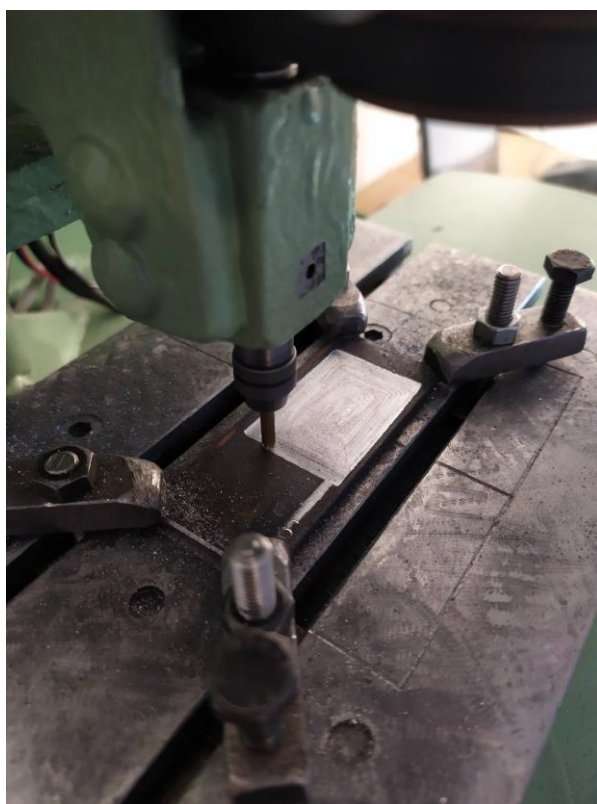
Slika 55. Poravnavanje čeličnog obratka
