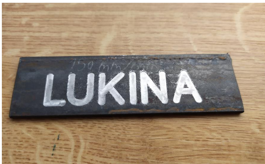
Slika 56. Gravirani natpis na čeličnom izratku, dubina 0,15 mm
