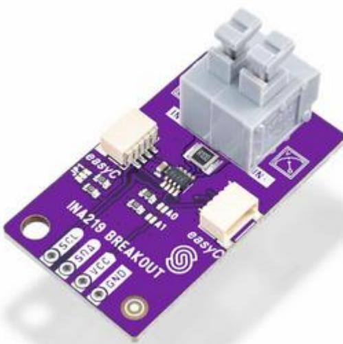
Slika 23 INA219 senzor struje i napona
