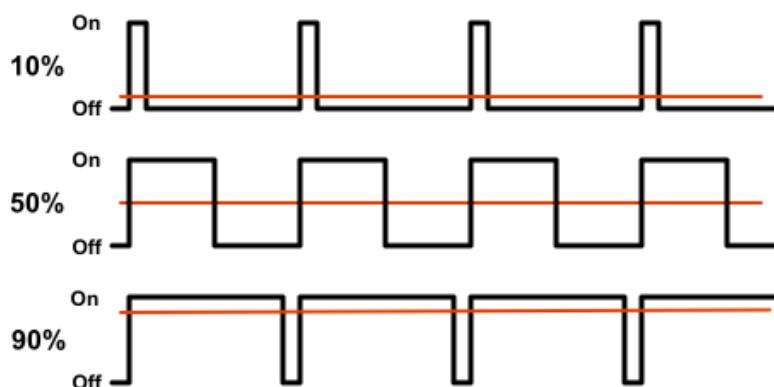
Slika 5 Ovisnost napona na motoru o popunjenoosti PWM signala
