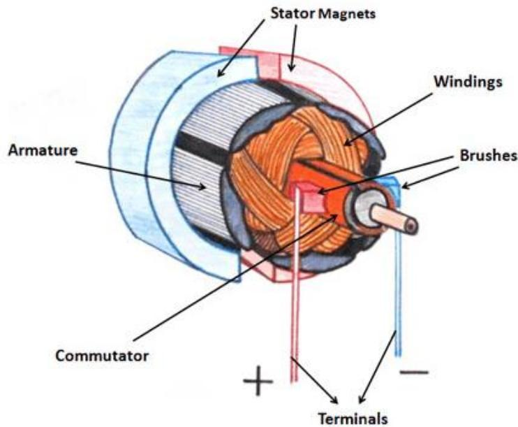
Slika 3 Pojednostavljen prikaz elektromotora sa permanentnim magnetima
