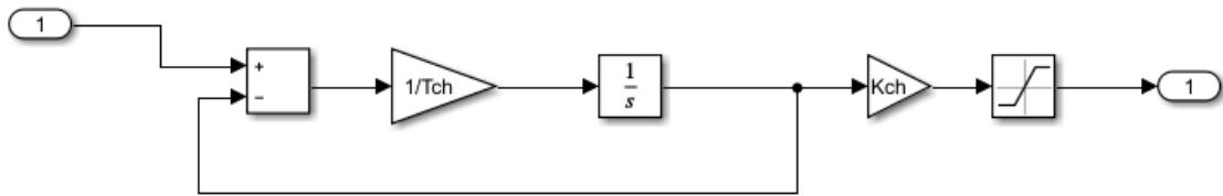
Slika 13 SIMULINK model energetskog pretvarača "choppera"
