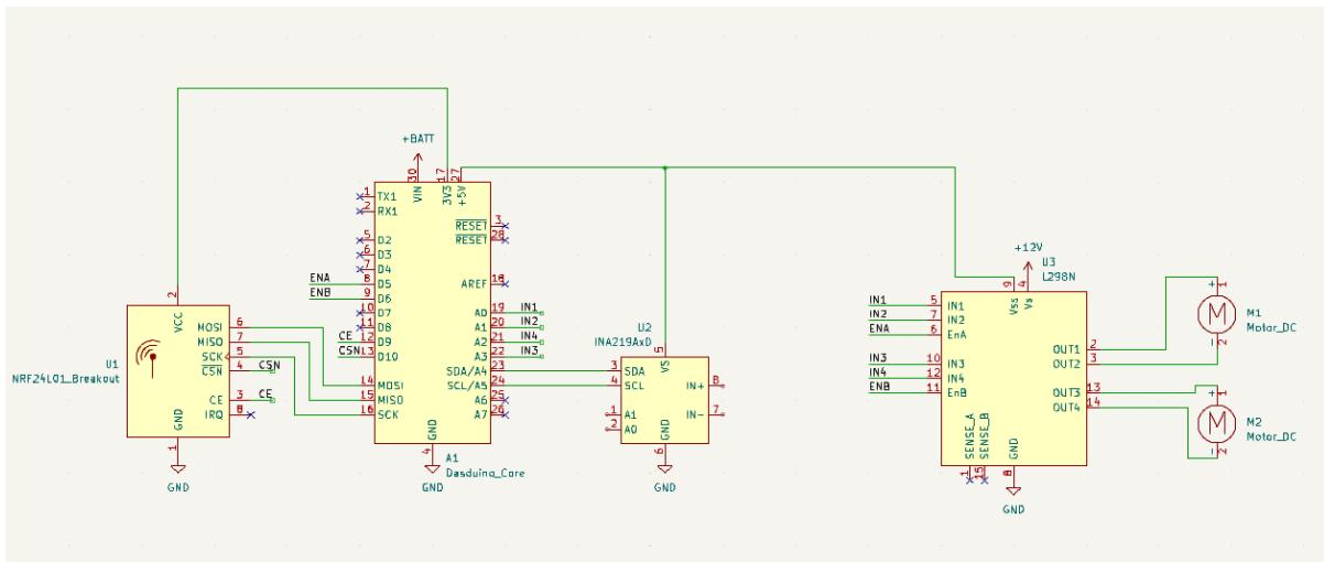
Slika 28 Schematic spoja komponenti na vozilu
