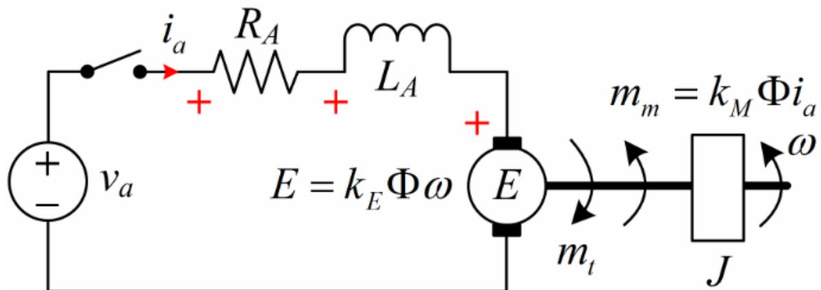
Slika 9 Sustav istosmjernog motora s nezavisnom konstantnom uzbudom
