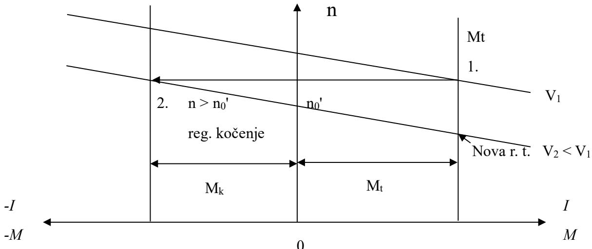
Slika 8 mehanička karakteristika istosmjernog motora pri regenerativnom kočenju
