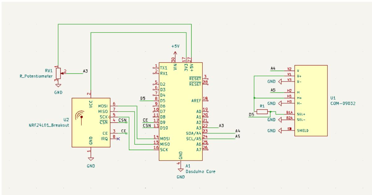
Slika 38 Shema spajanja komponenti na daljinskom upravljaču
