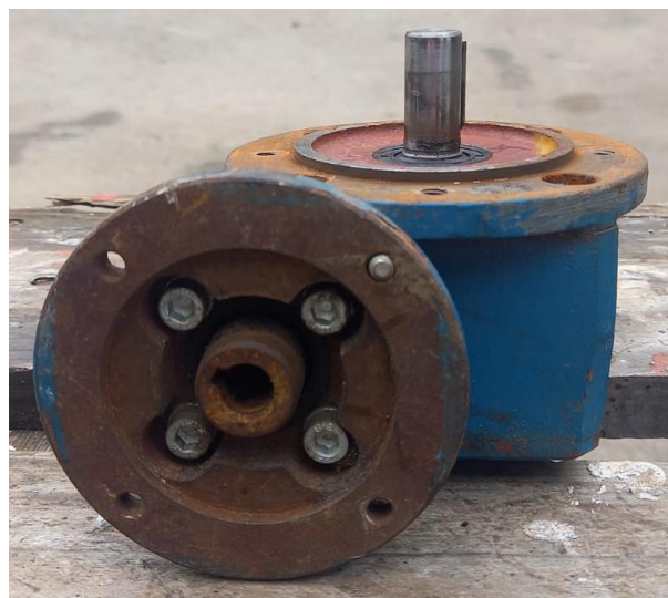
Slika 60. Reduktor za transportnu traku
