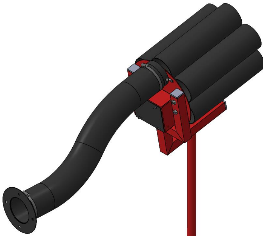
Slika 55. Spremnik optica sa mehanizmom za izbacivanje optica
