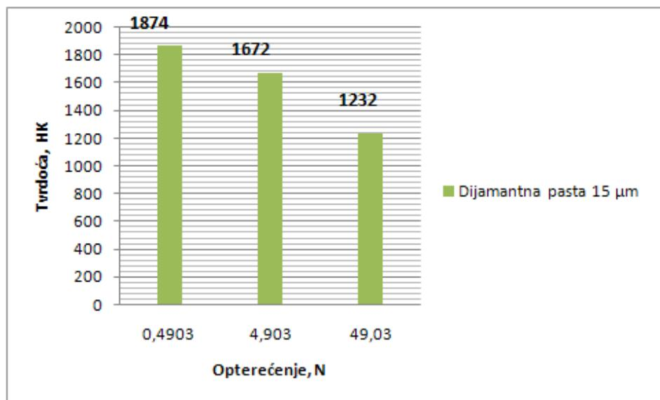
*Slika 54. Dijagramski prikaz Knoopove tvrdoće na površini poliranoj dijamantnom pastom veličine abraziva 15 µm*
