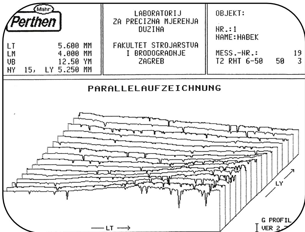
Slika 39. 3D prikaz rezultata mjerjenja hrapavosti površine brušene SiC papirom zrnatosti 4000
