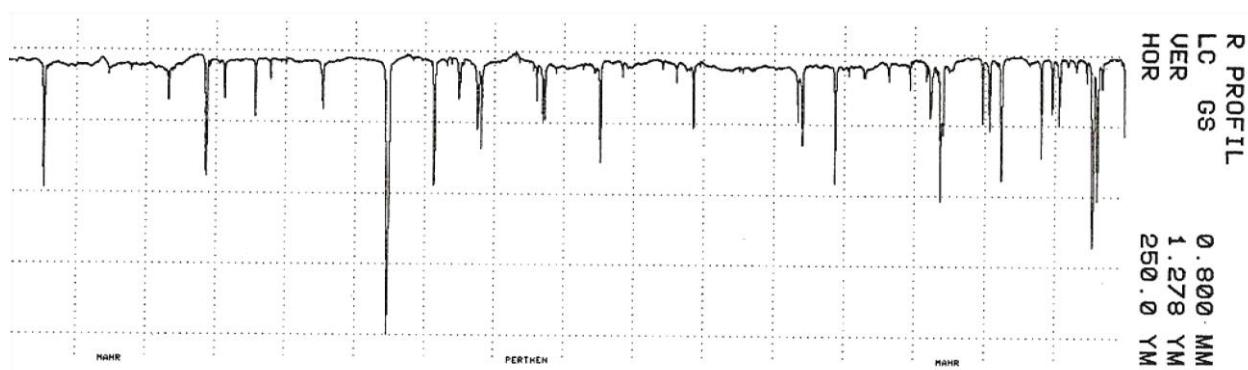
Slika 38. 2D prikaz rezultata mjerjenja hrapavosti površine brušene SiC papirom zrnatosti 4000
