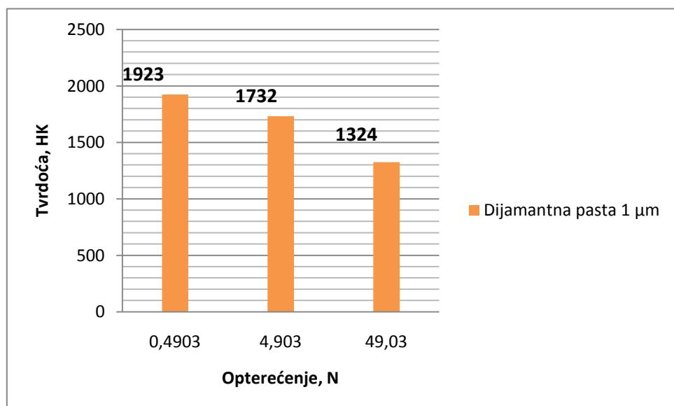
*Slika 55. Dijagramski prikaz Knoopove tvrdoće na površini poliranoj dijamantnom pastom veličine abraziva 1 µm*
