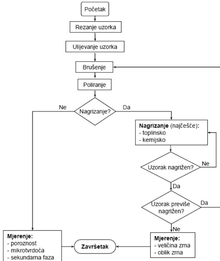
*Slika 28. Dijagram toka pripreme uzorka za keramografiju [19]*
