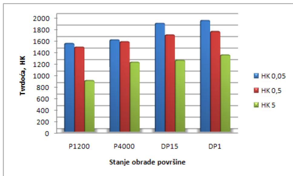
*Slika 56. Ovisnost Knoopove tvrdoće o stanju obrade površine*
