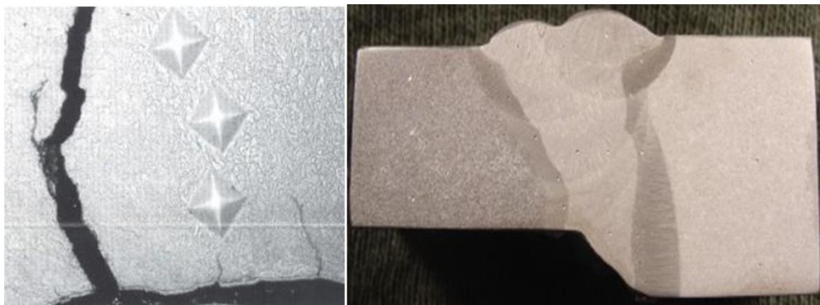
*Slika 10. Izgled otiska pri mjerenu mikrotvrdoće [9]*
