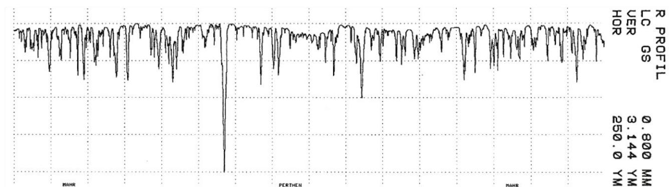
Slika 36. 2D prikaz rezultata mjerena hrapavosti površine brušene SiC papirom zrnatosti 1200
