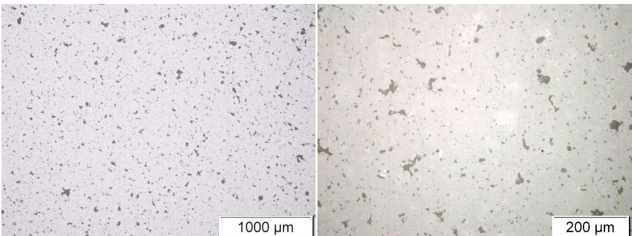
*Slika 33. Površina nakon poliranja dijamantnom pastom veličine abraziva 15  $\mu\text{m}$*
