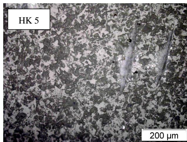
*Slika 48. Otisci Knoopovog indentora na površini brušenoj SiC papirom zrnatosti 1200*
