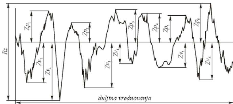
Slika 24. Određivanje maksimalne visine profila  $R_z$  [7]
