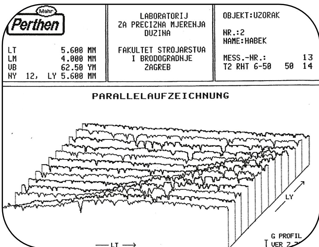
*Slika 37. 3D prikaz rezultata mjerena hrapavosti površine brušene SiC papirom zrnatosti 1200*
