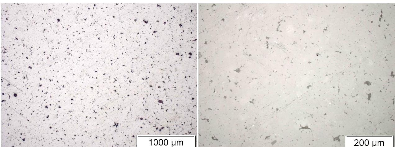
*Slika 34. Površina nakon poliranja dijamantnom pastom veličine abraziva 1  $\mu\text{m}$*
