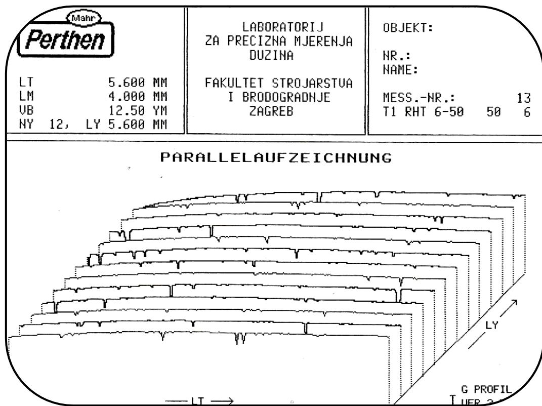
**Slika 43.** 3D prikaz rezultata mjerena hrapavosti površine polirane dijamantnom pastom veličine abraziva  $1 \mu\text{m}$
