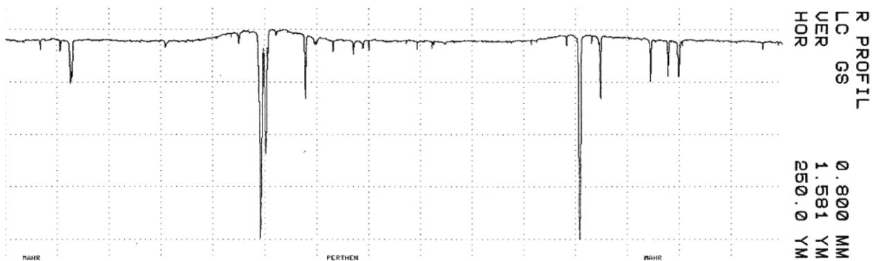
**Slika 42. 2D prikaz rezultata mjerenja hrapavosti površine polirane dijamantnom pastom
