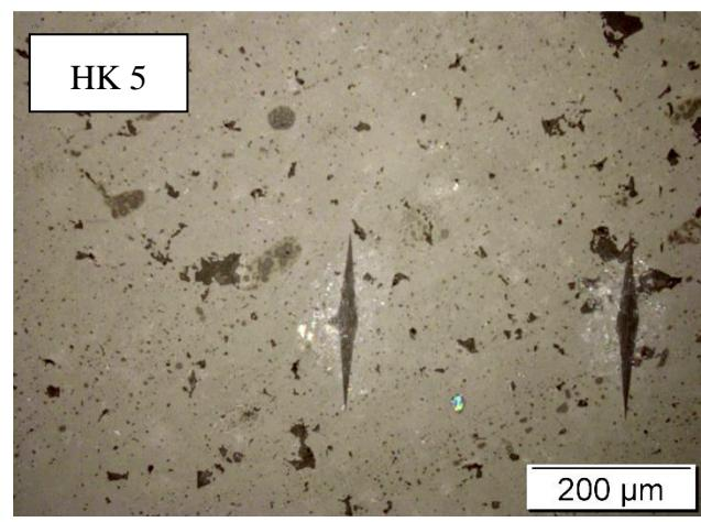
*Slika 51. Otisci Knoopovog indentora na površini poliranoj dijamantnom pastom
