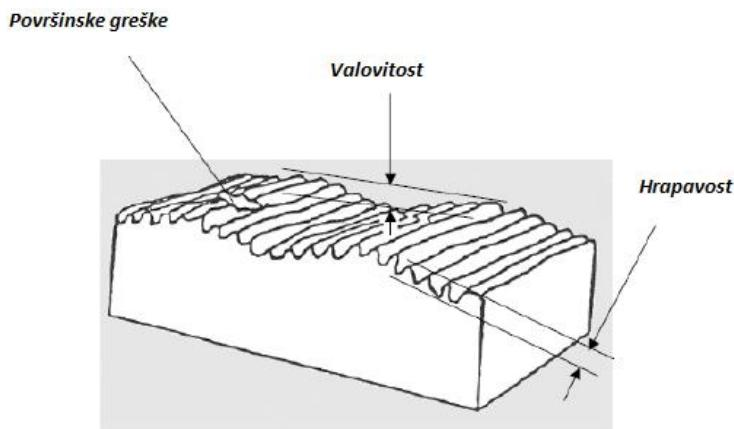
*Slika 22. Prostorni prikaz deformirane površine [7]*
