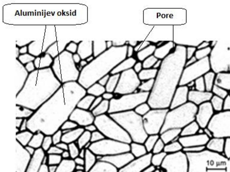
*Slika 6. Mikrostruktura aluminijeva oksida (99,7% kristala) [5]*
