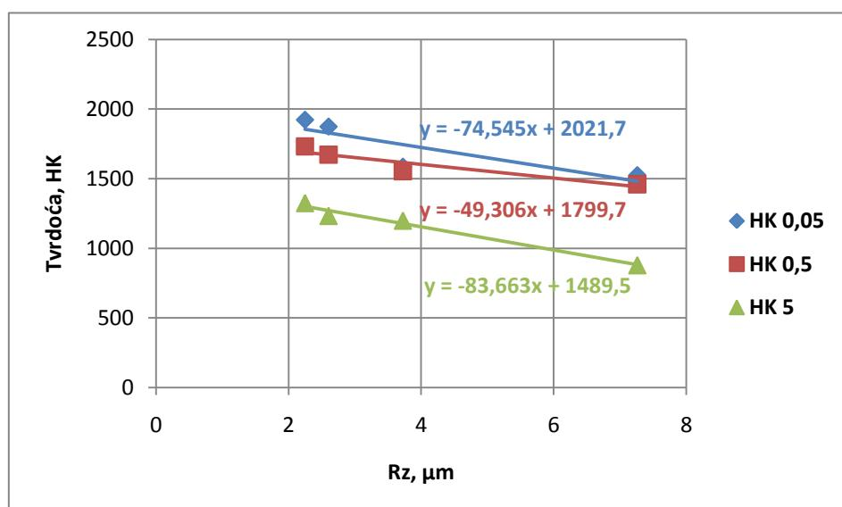
*Slika 59. Ovisnost Knoopove tvrdoće o parametru hrapavosti  $R_z$*
