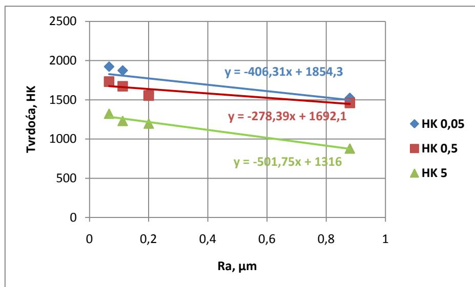
*Slika 58. Ovisnost Knoopove tvrdoće o parametru hrapavosti  $R_a$*
