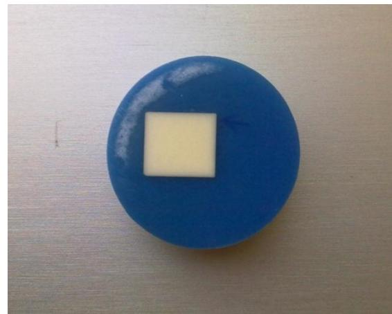
*Slika 29. Zaliveni keramički uzorak*
