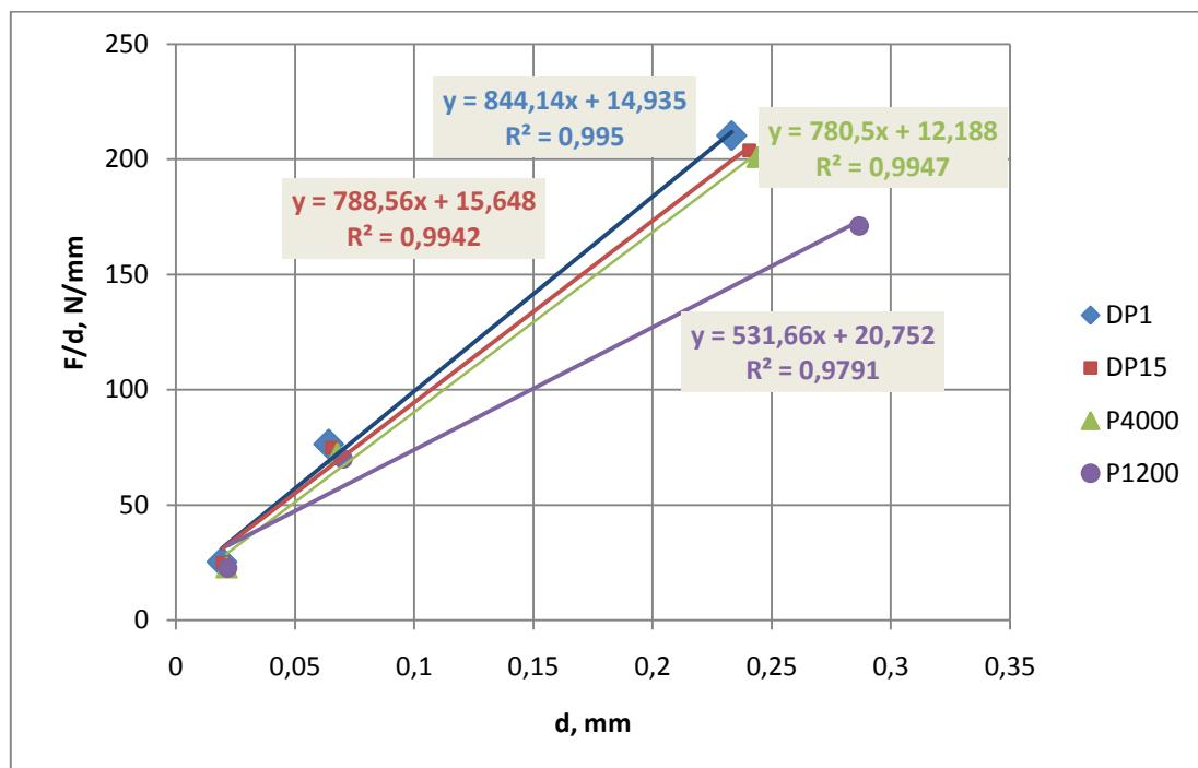
*Slika 61. Grafički prikaz ovisnosti  $F/d$  o  $d$  prema modelu otpornosti razmernom svojstvima uzorka*
