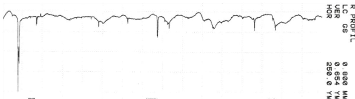
**Slika 40. 2D prikaz rezultata mjerjenja hrapavosti površine polirane dijamantnom pastom
