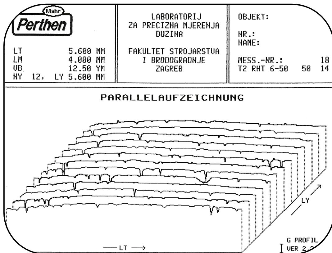
*Slika 41. 3D prikaz rezultata mjerena hrapavosti površine polirane dijamantnom pastom veličine abraziva  $15 \mu\text{m}$*
