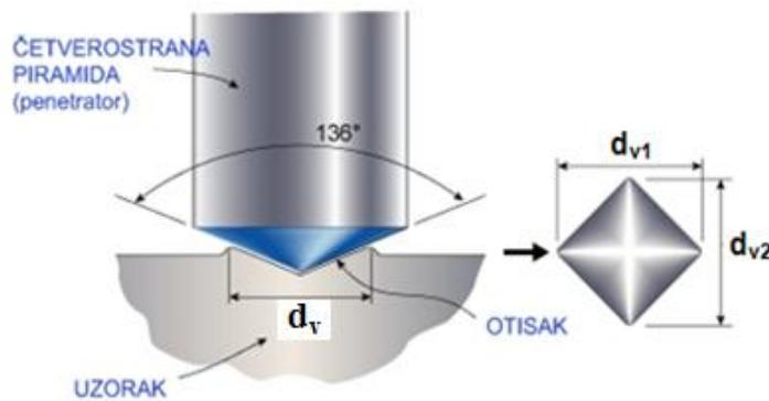
*Slika 13. Utiskivanje Vickersovog indentora i izgled otiska [13]*
