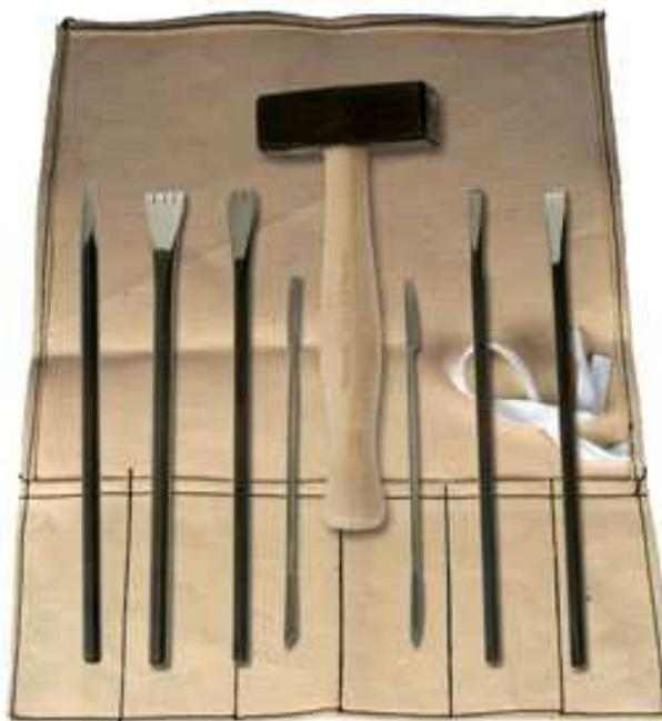
Slika 7. Set ručnog alata kamenoklesara
