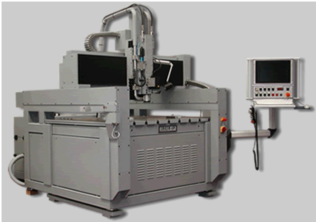
Slika 13. Numerički upravljeni stroj za graviranje kamena INCISOGRAFO MH 1000 [ 5 ]
