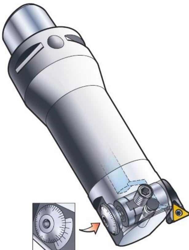
Slika 43. Alat za rastokarivanje sa jednom oštricom [3]
