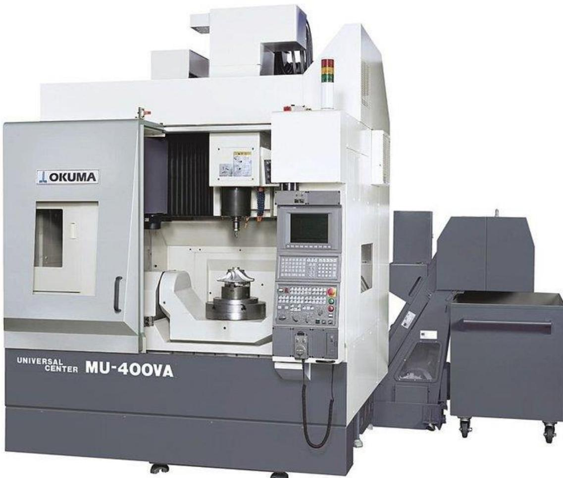
Slika 82. Pet-osni glodači obradni centar [8]
