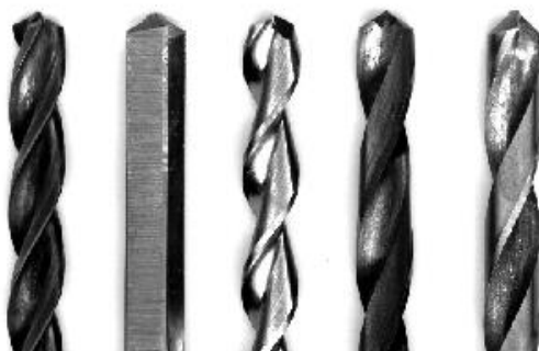
Slika 12. Svrkla sa različitim brojem oštrica [2]
