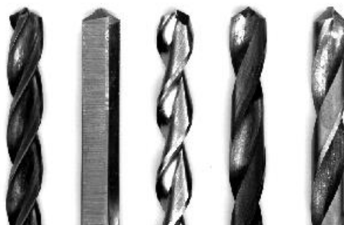
Slika 12. Svrkla sa različitim brojem oštrica [2]
