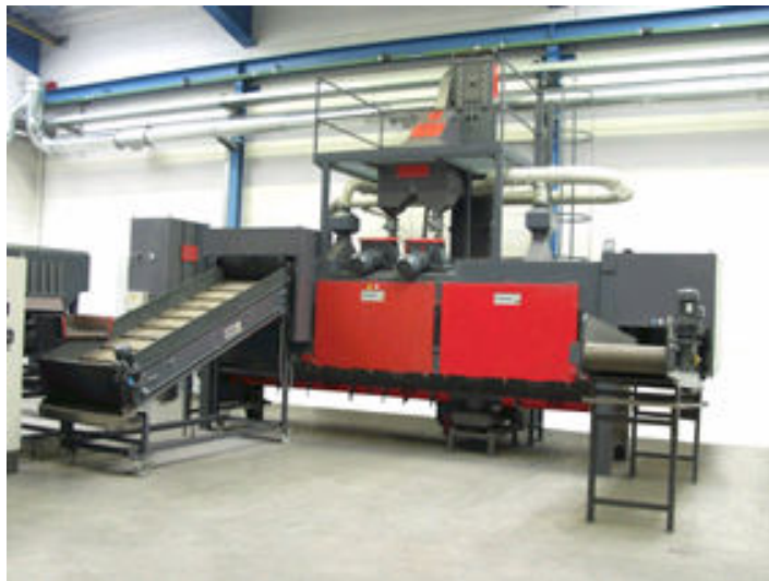
Slika 3.15 Tunelska sačmalica sa kontinuiranom trakom tvrtke Rösler tip RMBD 500 [12]
