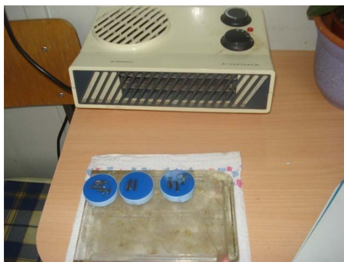
Slika 38. Prikaz sušenja uzoraka nakon brušenja.
