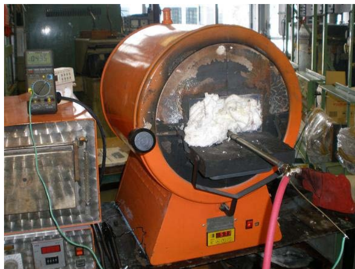
Slika 28. Oprema za provođenje postupka aluminiziranja
