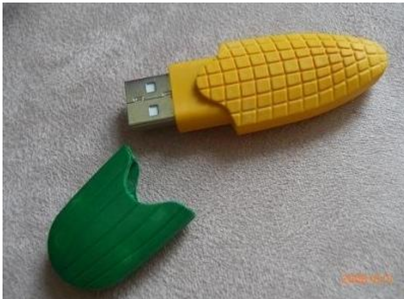
Slika 3.12.. Biorazgradiva USB memorija načinjena od PLA [11]
