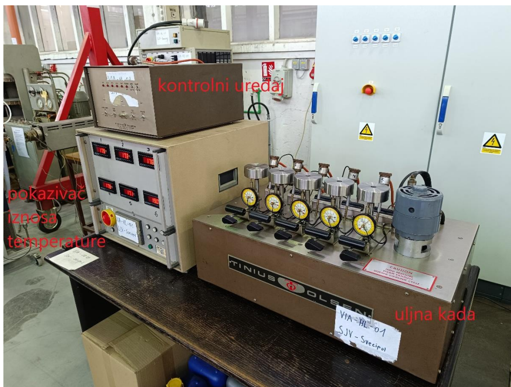
Slika 5.6. Oprema za provođenje postupka određivanja temperature omekšavanja po Vicatu
