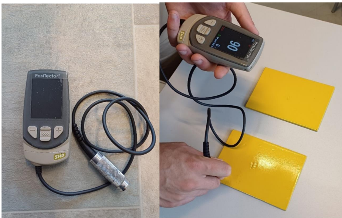
Slika 53. Mjerenje tvrdoće premaza uz pomoć uređaja „PosiTector“
